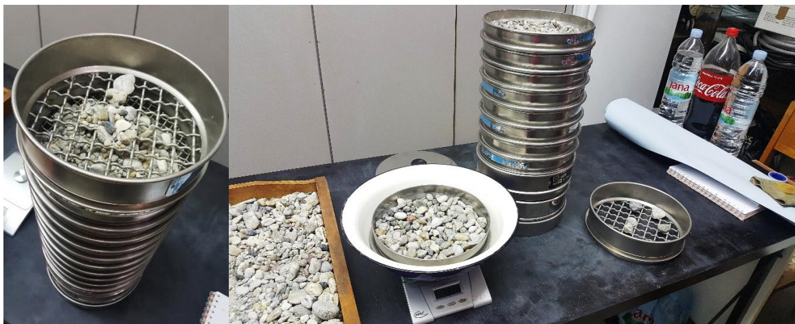
Slika 4.3 Postupak sisanja i vaganja
