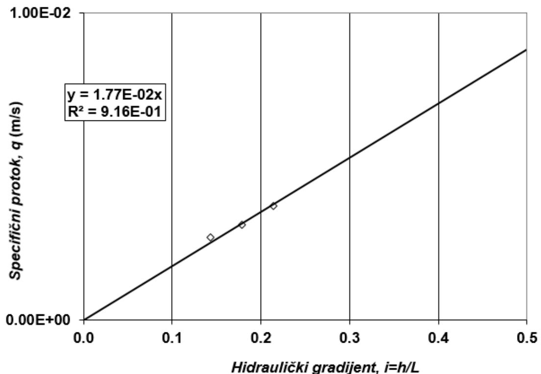
Slika 5.1 Graf ovisnosti specifičnog protoka i hidrauličkog gradijenta
