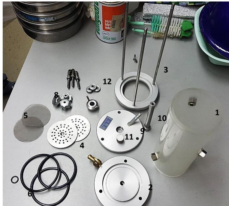
Slika 4.5 Dijelovi permeametra: (1) Ćelija permeametra, (2) donja bazna ploča s ventilom, (3) tronožac za učvršćivanje, (4) porozni disk, (5) filtarske mrežice, (6) gumice, (7) manometarske spojnice, (8) gornji navoji, (9) gornja ploča s otvorom, (10) potisni klip, (11) odzračni ventil, (12) donji navoji.
