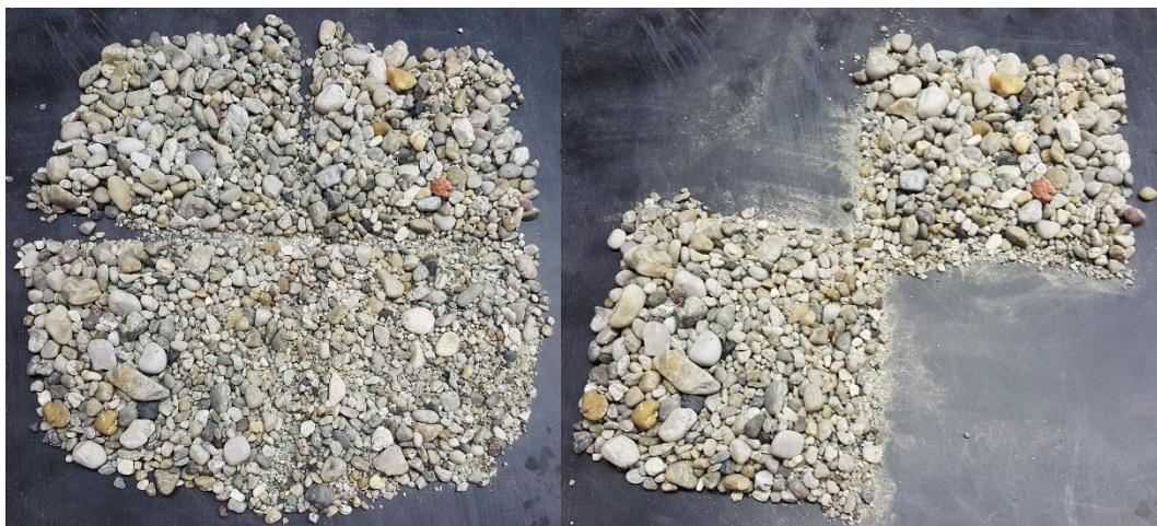
Slika 4.2 Četvrtanje uzorka
