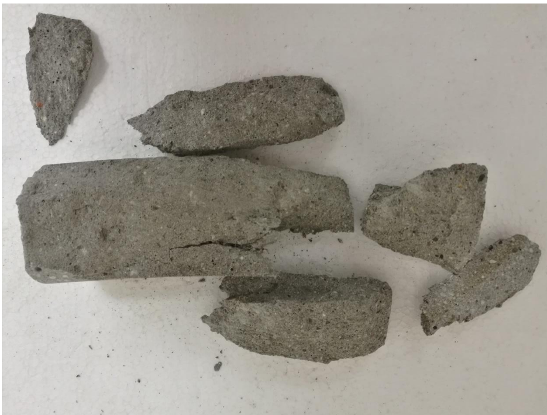
Slika 6-10. Prikaz uzorka 18-001-003 nakon sloma.
