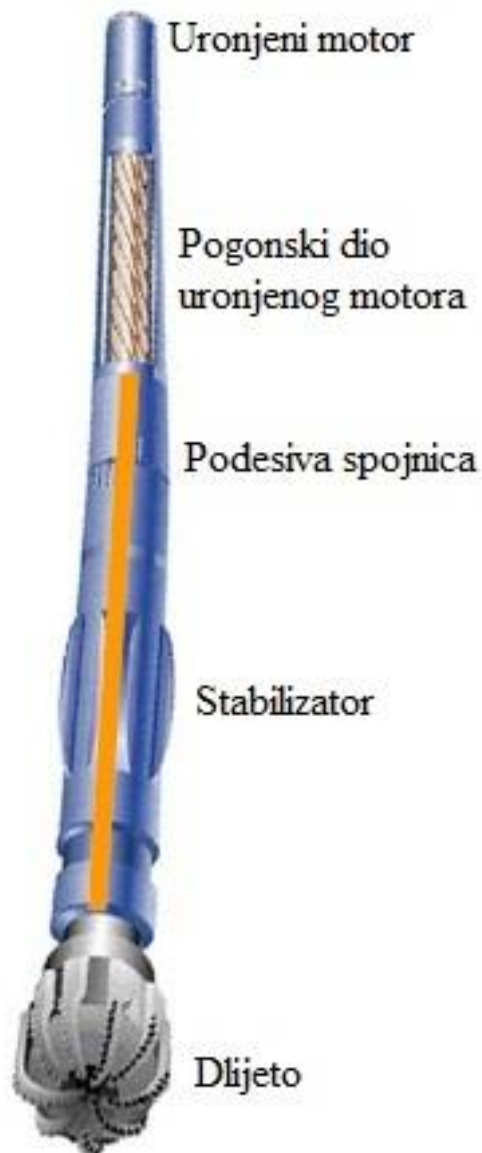
Slika 2-1. Primjer upravljivog sustava (Gaurina-Međimurec, 2015)
