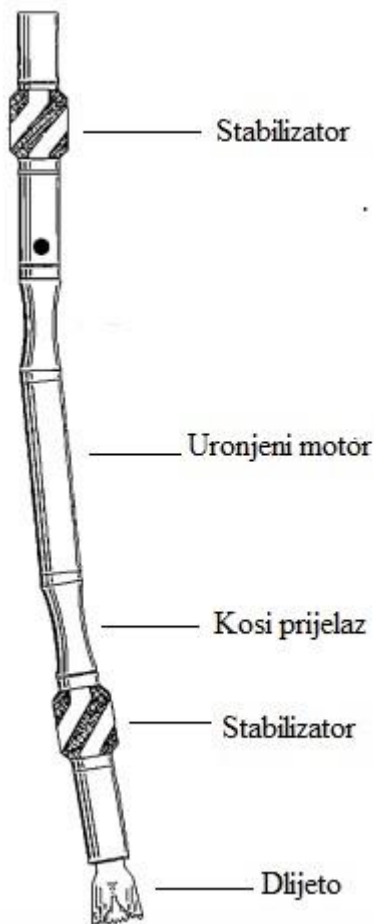
Slika 3-5. Sklop bušaćih alatki korišten za izradu bušotina srednjeg polumjera zakrivljenosti (Heaton i Rotel, 1990)
