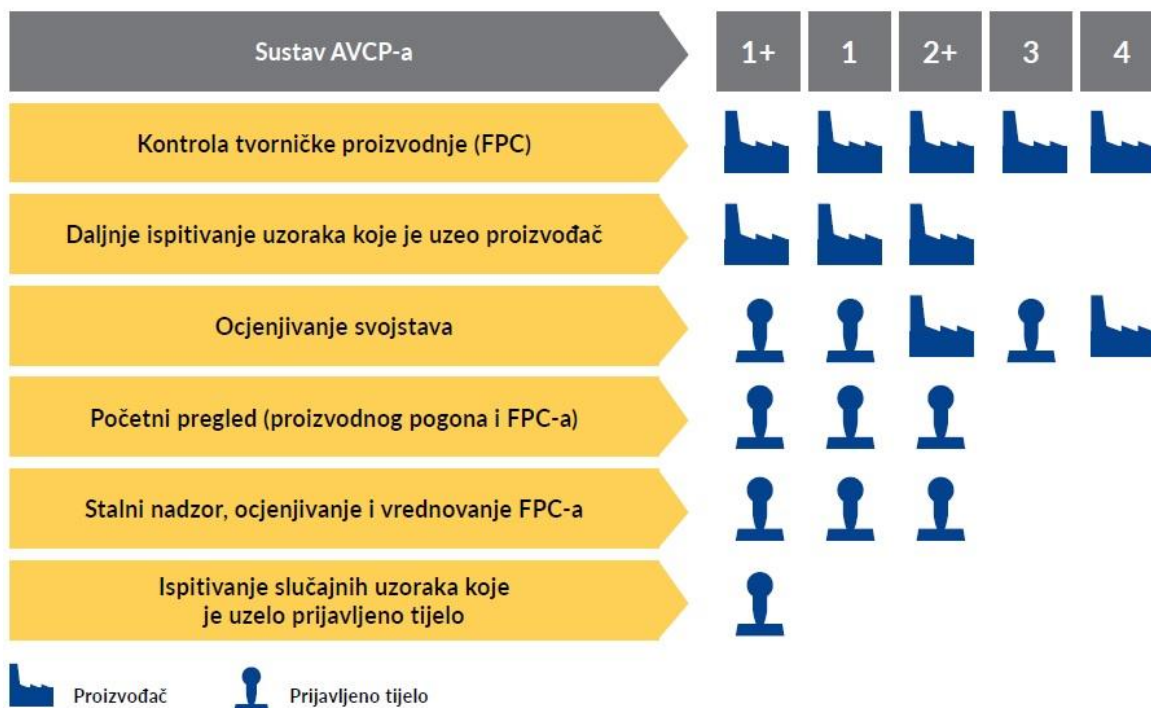
Slika 3-2 Shematski prikaz sustava ocjenjivanja i provjere stalnosti svojstava
