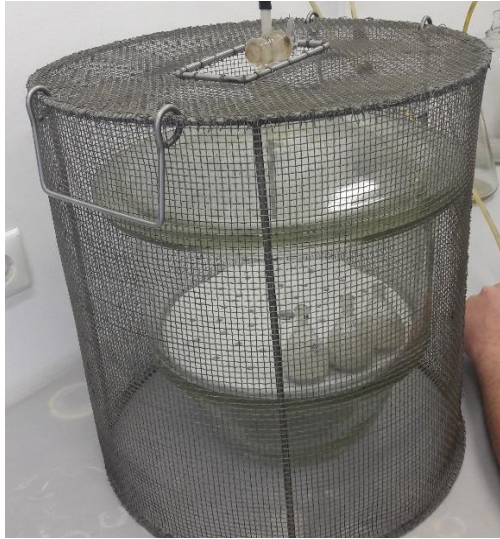
Slika 4-24 Ispuštanje zraka iz piknometra
