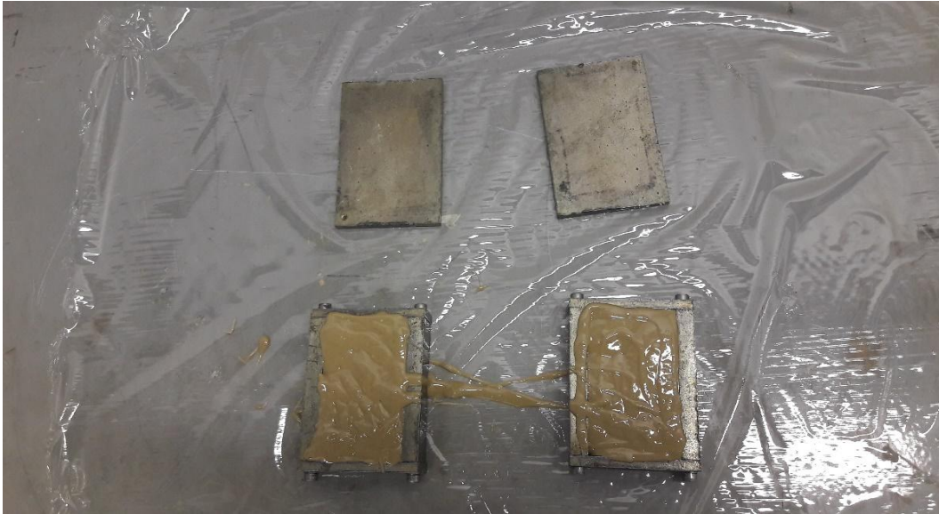
Slika 4-7 Epoxy smola postavljena u kalupe
