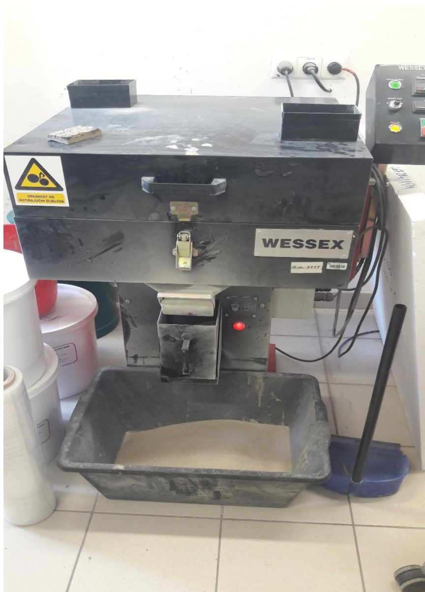
Slika 4-9 Uređaj za ispitivanje otpornosti na abraziju
