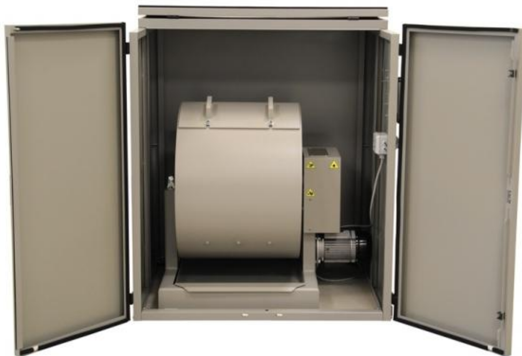
Slika 4-4 Uređaj za ispitivanje agregata na otpornost (LA)
