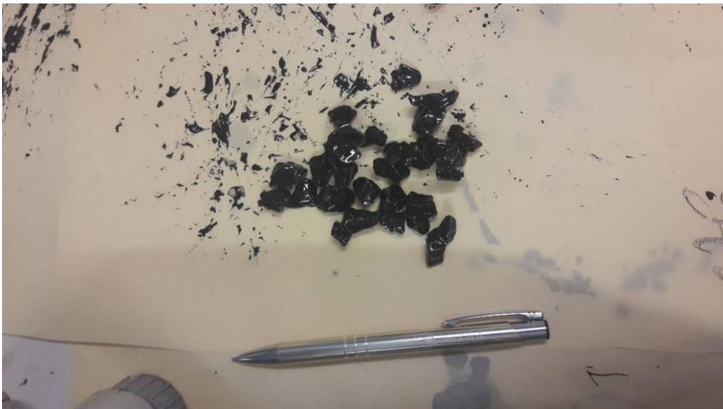
Slika 4-18 Agregat potpuno pomiješan s bitumenom
