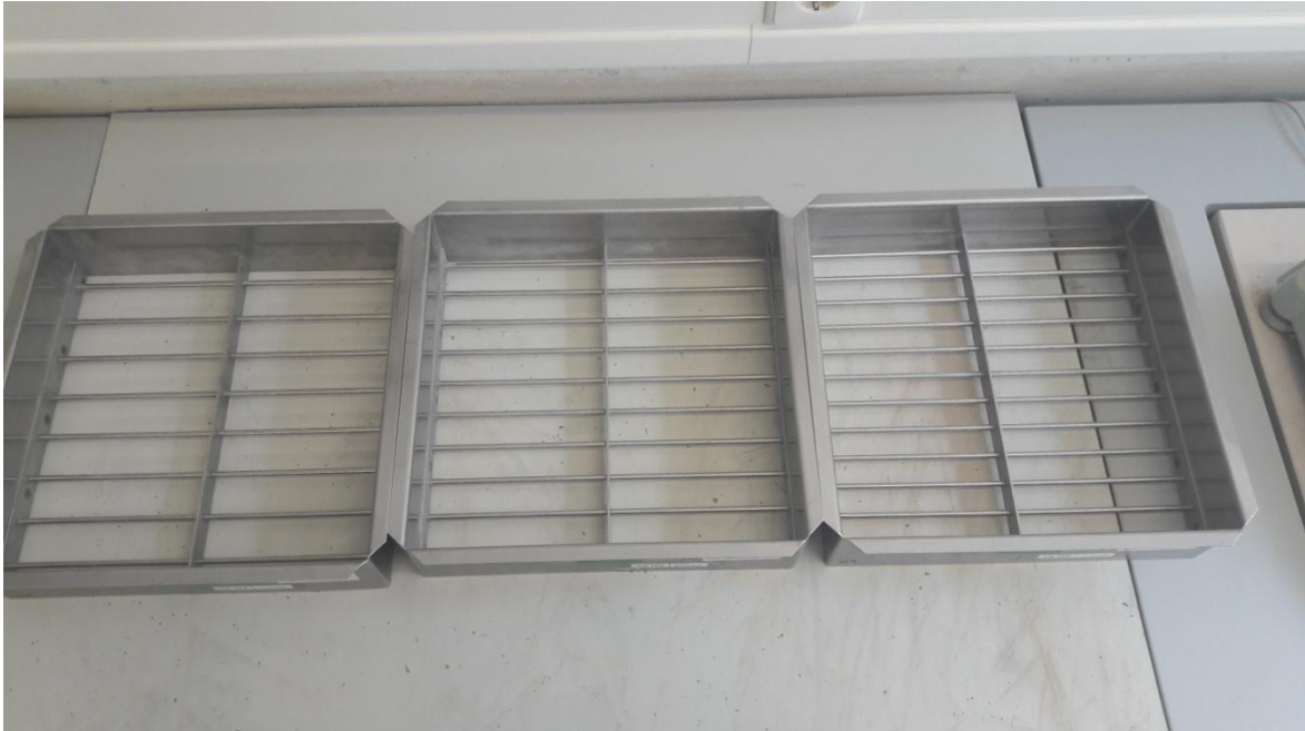
Slika 4-3 Rešetke za određivanje plosnatosti zrna
