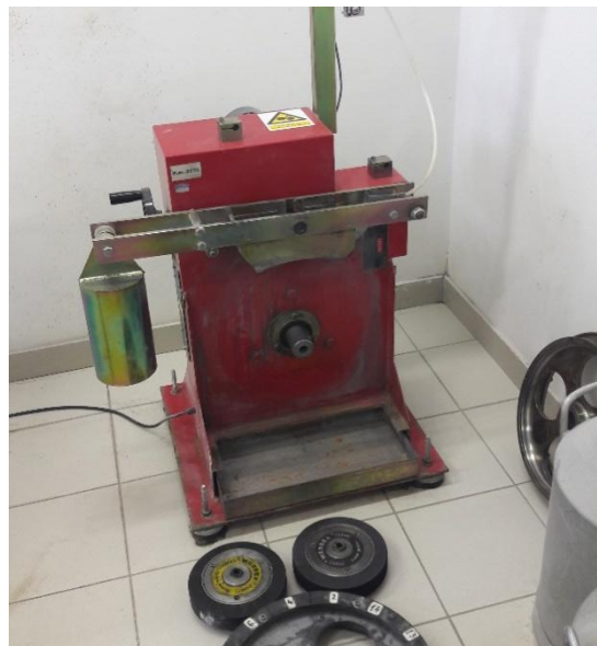
Slika 4-13 Uređaj za ispitivanje otpornosti na polirnost
