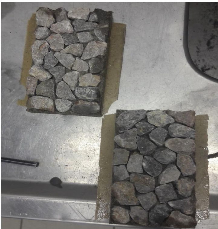
Slika 4-8 Pripremljeni uzorci za abraziju
