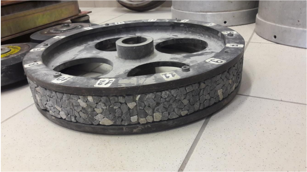
Slika 4-12 Kotač s pločicama
