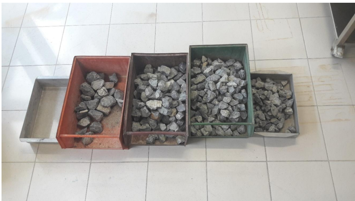
Slika 4-1 Granulometrijska analiza uzorka tucanika
