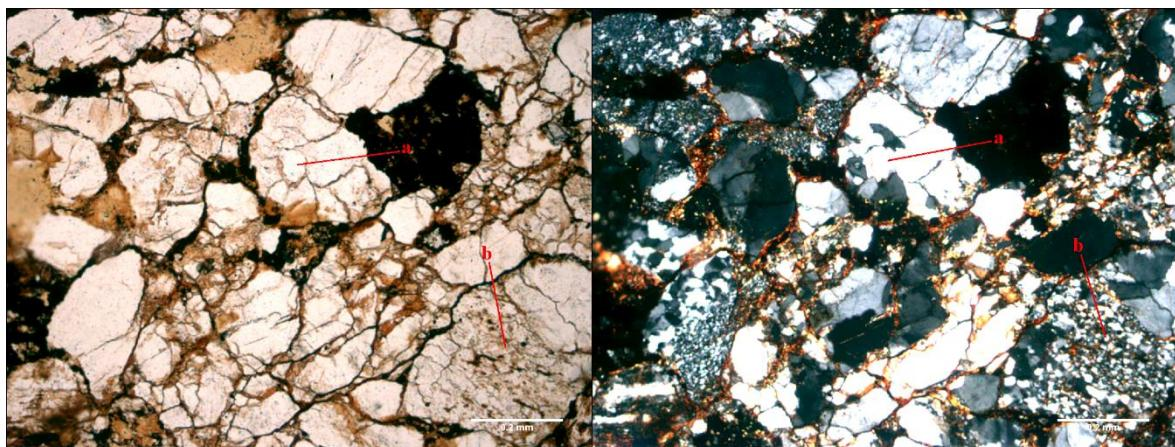
Slika 6-6. Mikropetrografska sastav uzorka G-2a. Desno je fotografija s uključenim analizatorom, a lijevo bez. Oznake: a-litični fragment (fragment kvarcita), b-litični fragment (fragment vulkanita ili rožnjaka). Mjerilo je duljine 0,2 mm.
