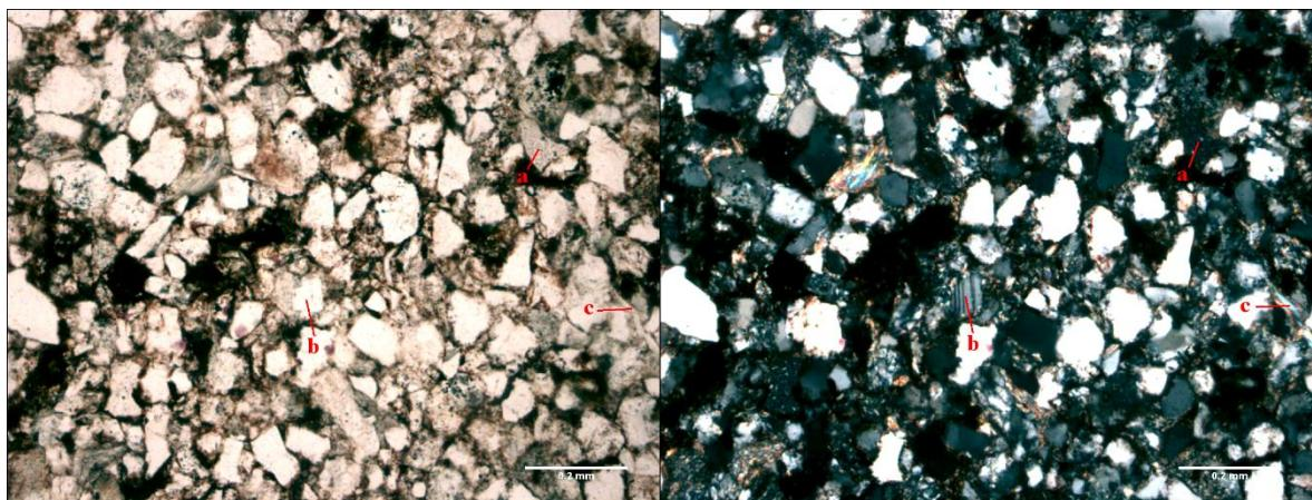
Slika 6-7. Mikropetrografska sastav uzorka G-3, a. Desno je fotografija s uključenim analizatorom, a lijevo bez. Oznake: a-litični fragment (fragment škriljavca), b-plagioklas, c-muskovit. Mjerilo je duljine 0,2 mm.
