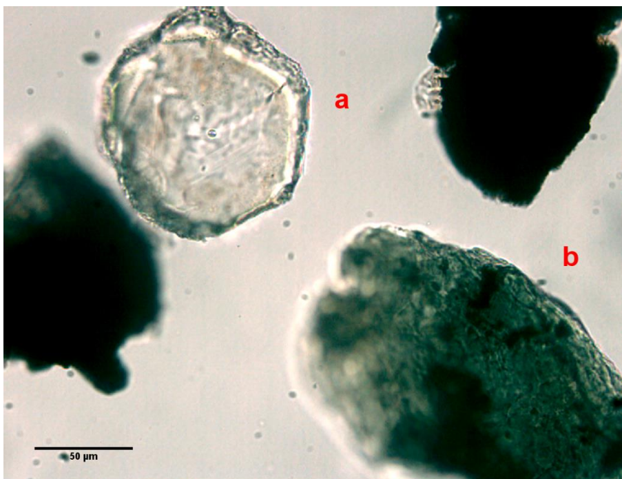
Slika 6-23. Apatit i klorit, uzorak Gröden pš. locus typicus . Oznake: a-izometrično zrno apatita, visokog stupnja zaobljenosti i sfericiteta, b-zrno klorita.
