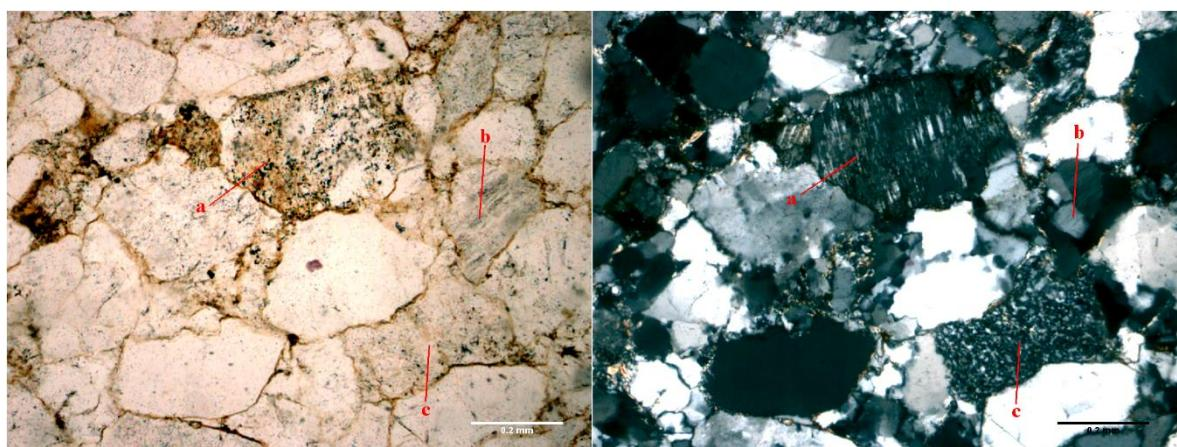
Slika 6-5. Mikropetrografska sastav uzorka G-2. Desno je fotografija s uključenim analizatorom, a lijevo bez. Oznake: a-ortoklas, b-litični fragment (polimineralni kvarc), c-litični fragment (fragment sedimentne stijene). Mjerilo je duljine 0,2 mm.
