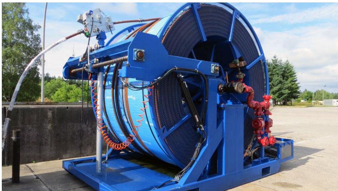
Slika 3-4. Bubanj s namotanim savitljivim tubingom i ostalom pripadajućom opremom (BJ Services, 2018)
