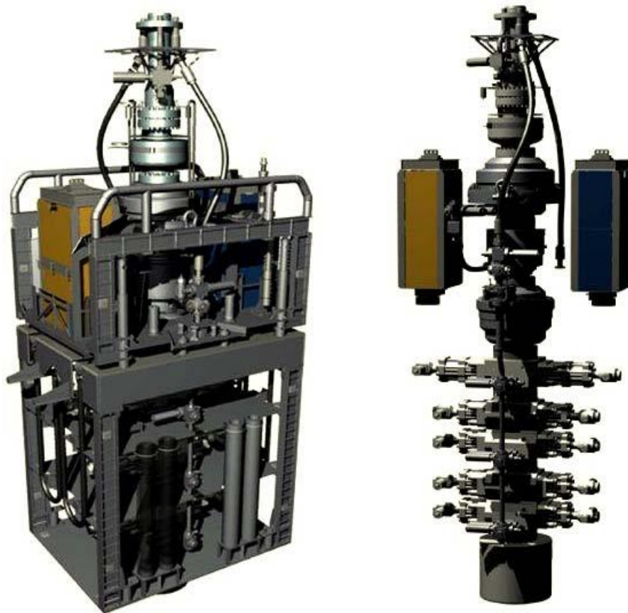
Slika 2-20. Cameronov BOP sklop s dvjema spojnica instaliranim na dnu donjeg BOP sklopa i između donjeg BOP sklopa i LMRP-a (Jaap Peetsold)
