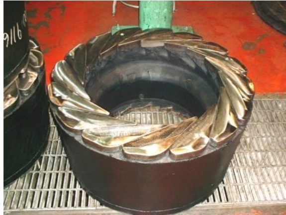
Slika 2-13. Radna guma prstenastog preventera proizvođača Cameron (Cameron DL Annular Blowout Preventer)
