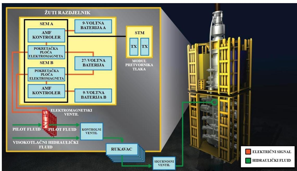
Slika 3-9. Shema podvodnog električnog modula s povezanim dijelovima sustava (National Comission On The BP Deepwater Horizon Oil Spill And Offshore Drilling, 2011)
