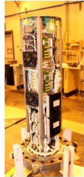
Slika 3-10. Podvodni elektronički modul sa i bez kućišta (Engineering Services Lp, 2014)
