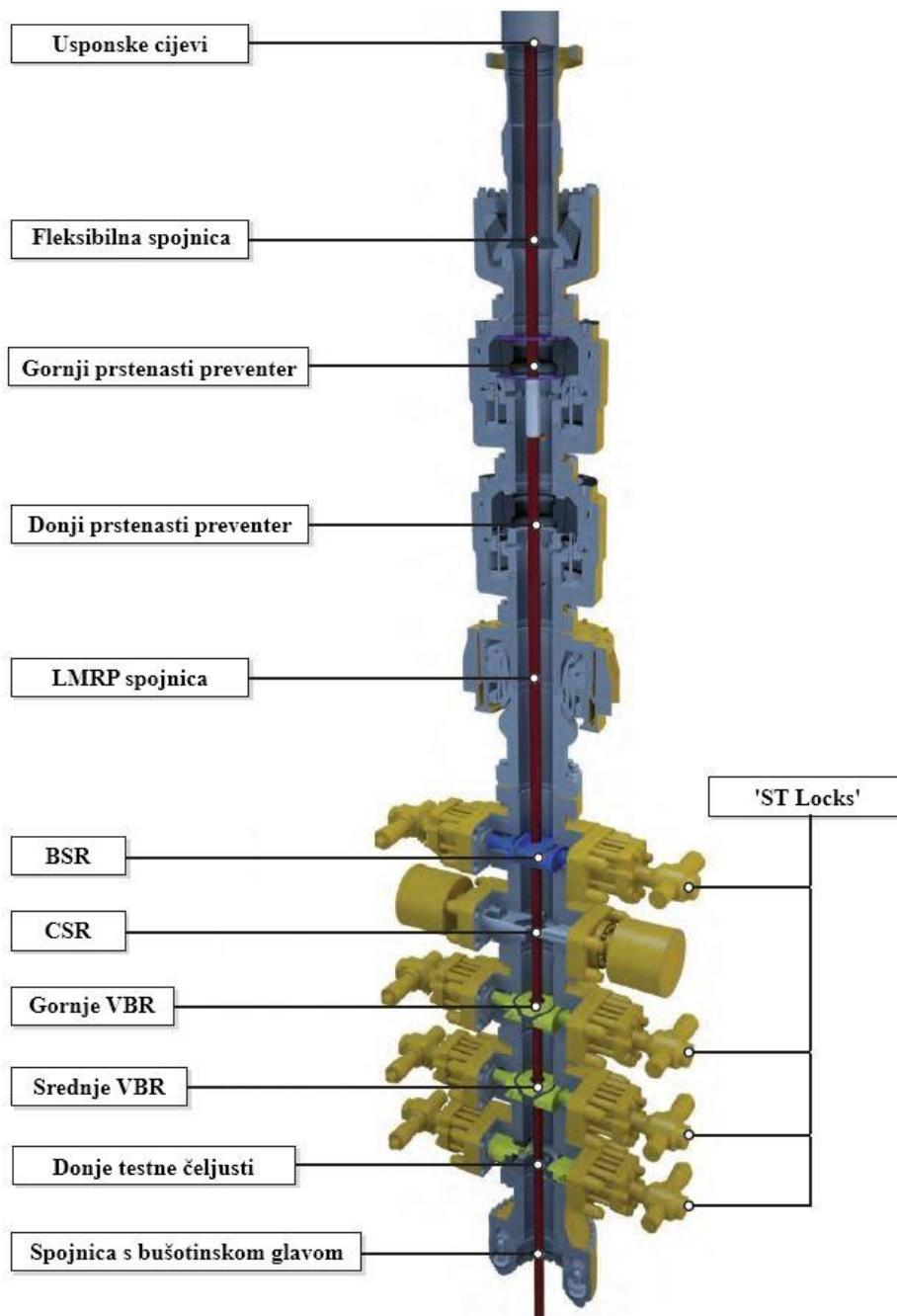
Slika 2-2. Presjek BOP sklopa platforme Deepwater Horizon sa sastavnim dijelovima
