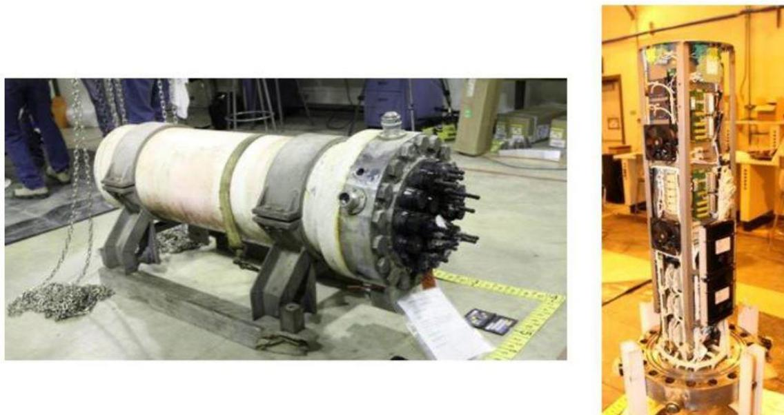
Slika 3-10. Podvodni elektronički modul sa i bez kućišta (Engineering Services Lp, 2014)
