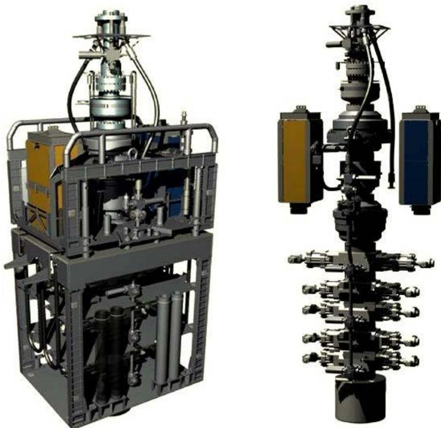
Slika 2-20. Cameronov BOP sklop s dvjema spojnicama instaliranim na dnu donjeg BOP sklopa i između donjeg BOP sklopa i LMRP-a (Jaap Peetsold)
