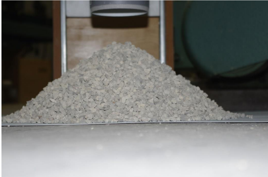
Slika 5-3. Formirana hrpa materijala nakon podizanja cilindra
