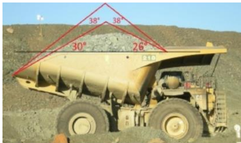
Slika 3-9. Prikaz razlike u volumenu s različitim kutovima sipanja (Lang, 2010)
