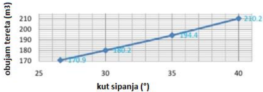
Slika 3-10. Utjecaj kuta sipanja na volumen materijala (Lang, 2010)
