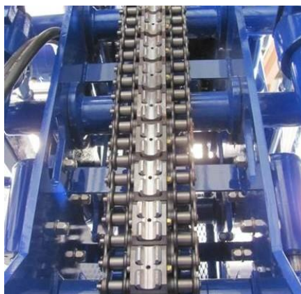
Slika 4-16. Tarni segmenti za obuhvaćanje određenog promjera (Power Hydraulics Engineering and Manufacturing, 2018)
