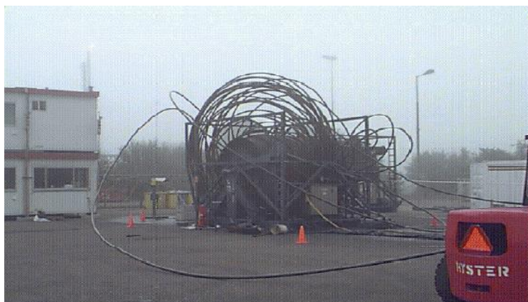
Slika 4-13. Primjer loše manipulacija savitljivim tubingom (CTES, 2005)
