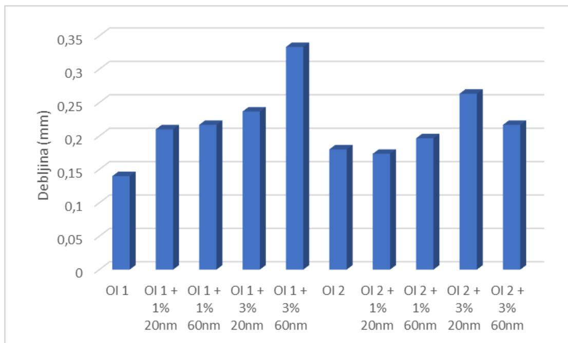
**Slika 5-18.** Debljine izmjerениh isplačnih obloga ispitivanih isplaka
