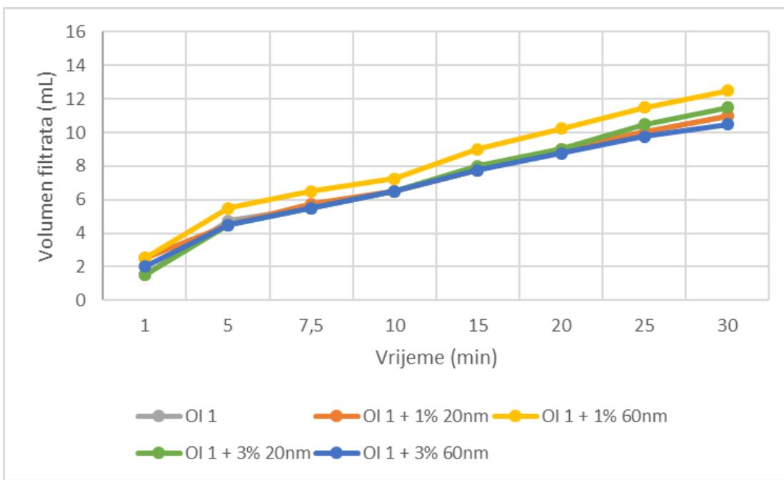
**Slika 5-14.** Rezultati mjerena volumena filtrata tijekom ispitivanja API filtracije bentonitnih isplaka
