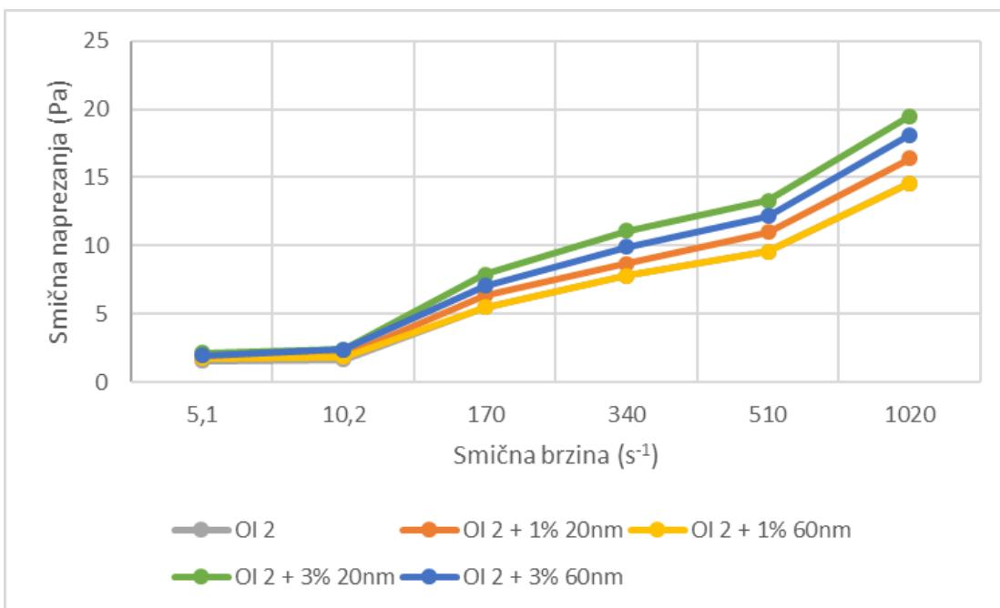
**Slika 5-6.** Ovisnost smičnih naprezanja o smičnim brzinama polimernih isplaka pri  $50\text{ }^{\circ}\text{C}$
