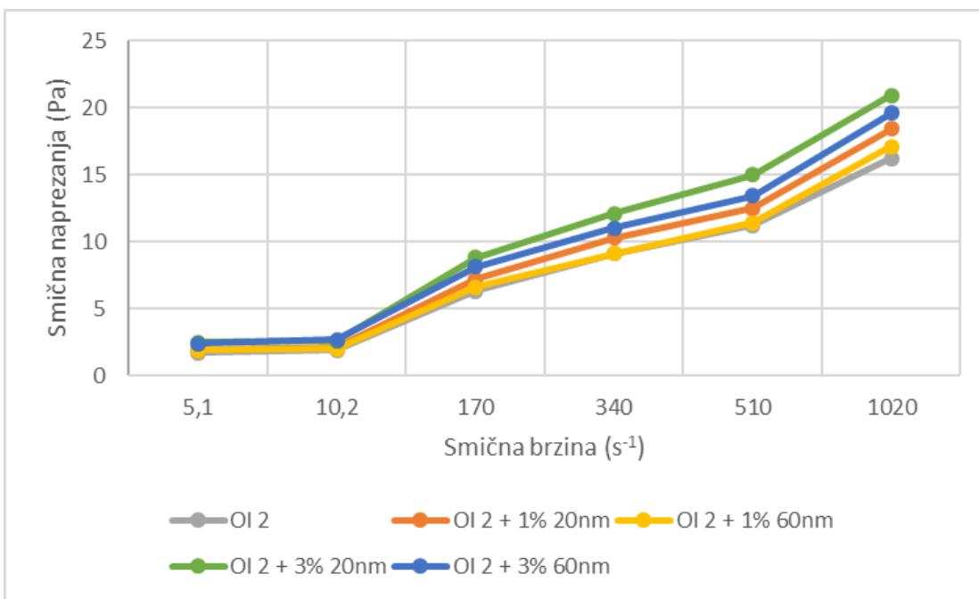
**Slika 5-5.** Ovisnost smičnih naprezanja o smičnim brzinama polimernih isplaka pri  $25\text{ }^{\circ}\text{C}$
