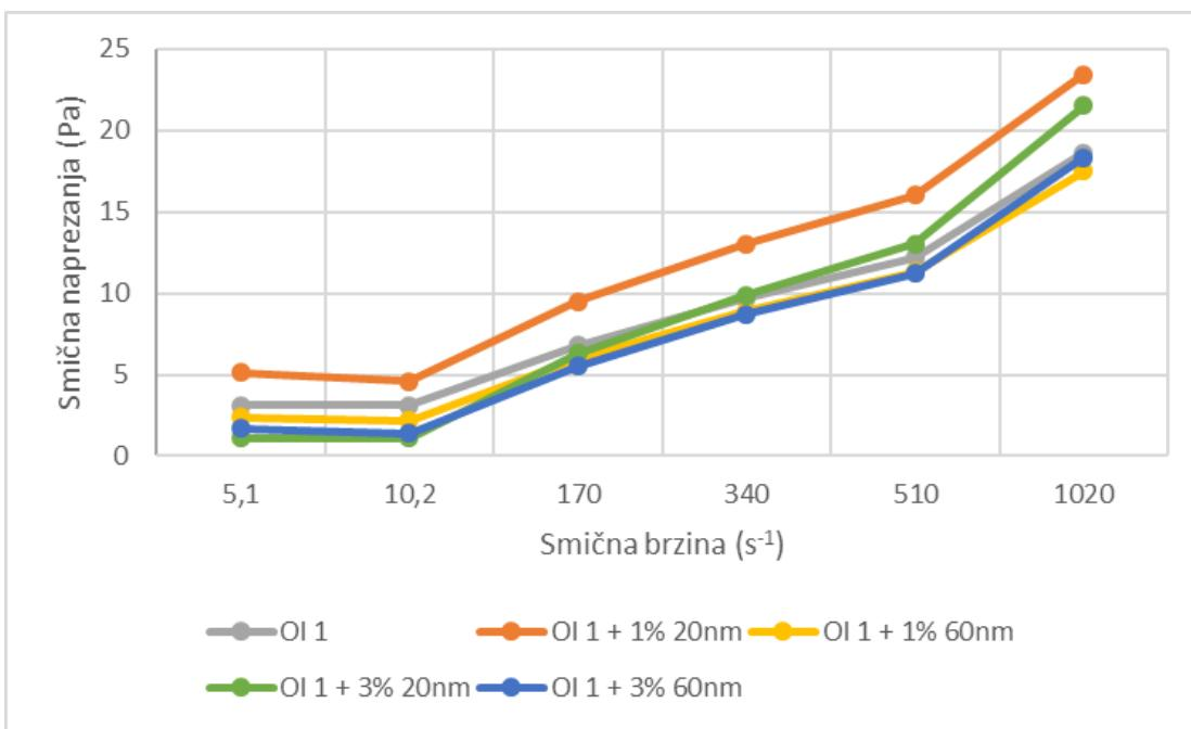
**Slika 5-2.** Ovisnost smičnih naprezanja o smičnim brzinama bentonitnih isplaka pri  $25\text{ }^{\circ}\text{C}$
