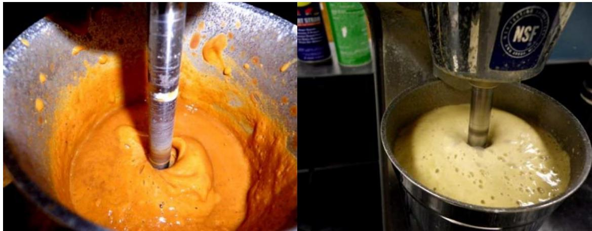
**Slika 2-1.** Izgled isplaka korištenih za ispitivanje (Nwaoji et al., 2013)
