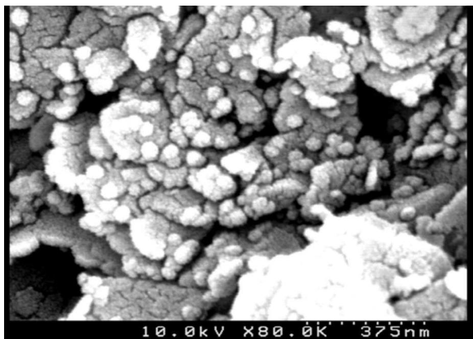
**Slika 2-5.** Snimak nanočestica (20 nm) unutar pora Atoka šejla (Sensoy et al., 2009)
