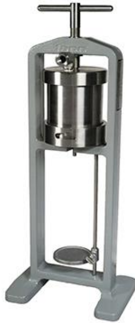
Slika 3-1. Uređaj za mjerenje vrijednosti statičke API filtracije (Hamdon, 2015)
