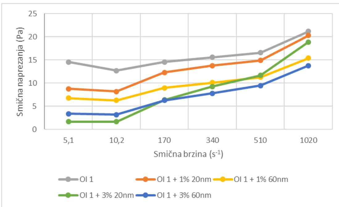
**Slika 5-4.** Ovisnost smičnih naprezanja o smičnim brzinama bentonitnih isplaka pri  $75\text{ }^{\circ}\text{C}$
