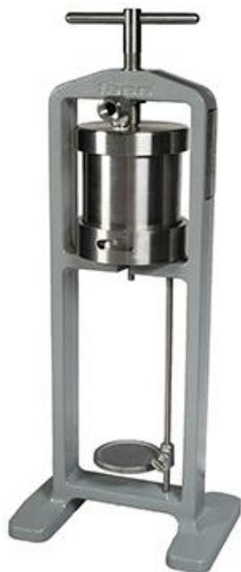
**Slika 3-1.** Uređaj za mjerjenje vrijednosti statičke API filtracije (Hamdon, 2015)
