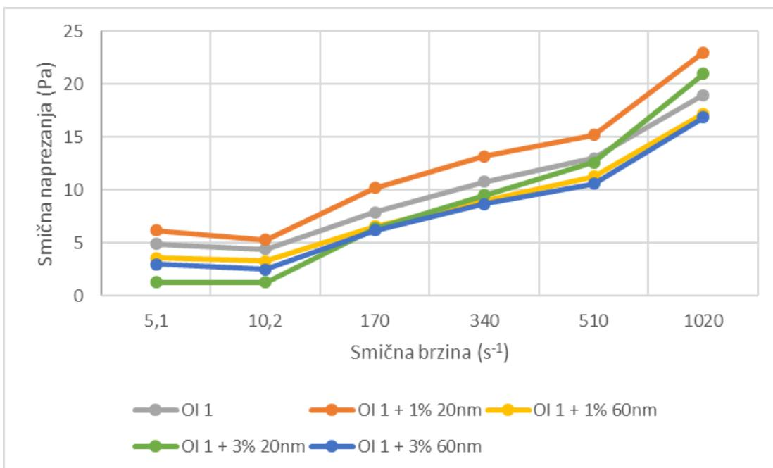
**Slika 5-3.** Ovisnost smičnih naprezanja o smičnim brzinama bentonitnih isplaka pri  $50\text{ }^{\circ}\text{C}$
