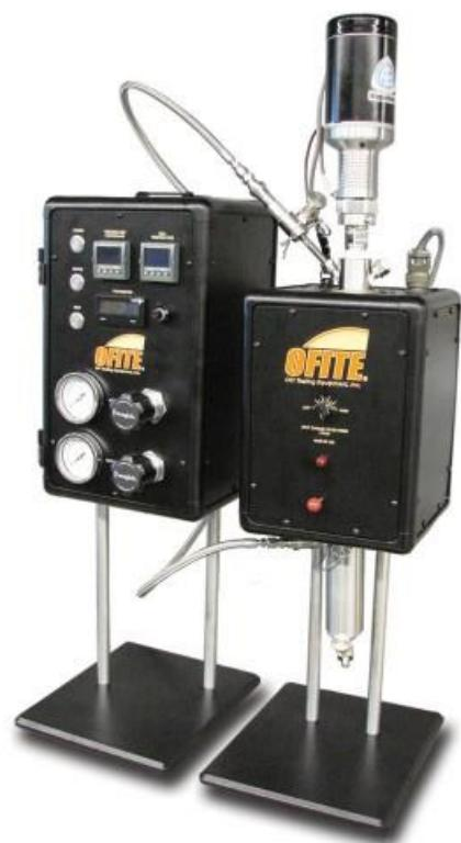
**Slika 3-2.** Uređaj za mjerjenje dinamičke HTHP filtracije (OFI Testing Equipment, 2014a)
