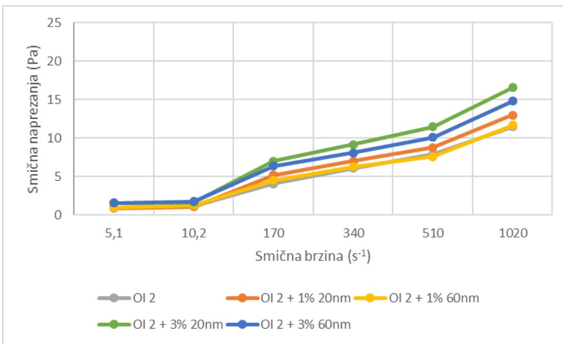
**Slika 5-7.** Ovisnost smičnih naprezanja o smičnim brzinama polimernih isplaka pri 75 °C
