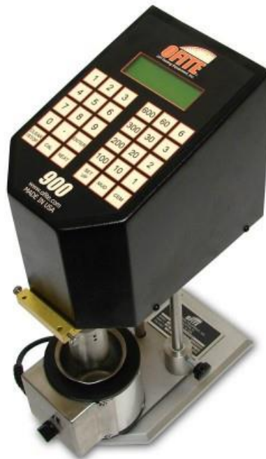
Slika 5-1. Model korištenog viskozimetra (OFI Testing Equipment Inc., 2015)
