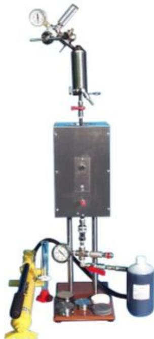
**Slika 3-3.** Uredaj za mjerenje PPT filtracije (OFI Testing Equipment, Inc, 2014b)
