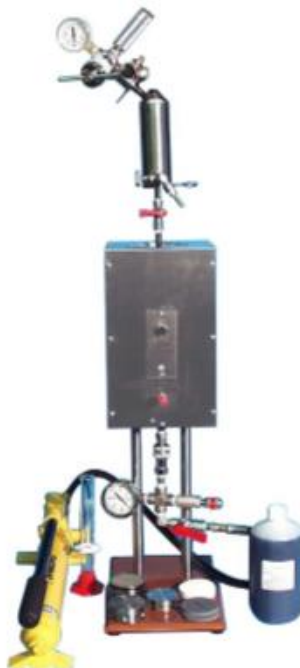
Slika 3-3. Uređaj za mjerenje PPT filtracije (OFI Testing Equipment, Inc, 2014b)
