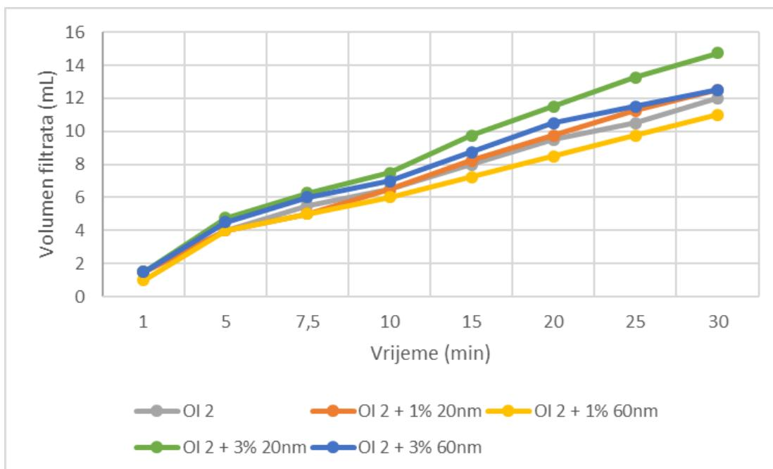
**Slika 5-15.** Rezultati mjerena volumena filtrata tijekom ispitivanja API filtracije polimernih isplaka
