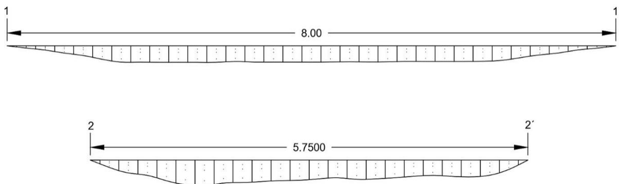
Slika 4-4. Mjerne točke hidrometrijskih profila 1-1' i 2-2'
