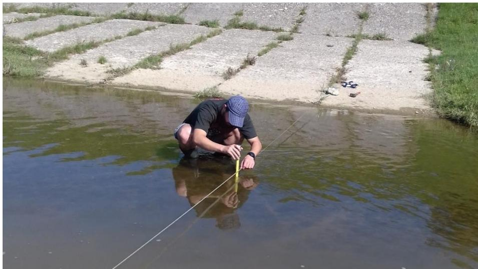
Slika 2-6. Mjerenje dubine profila i definiranje točaka mjerenja brzine
