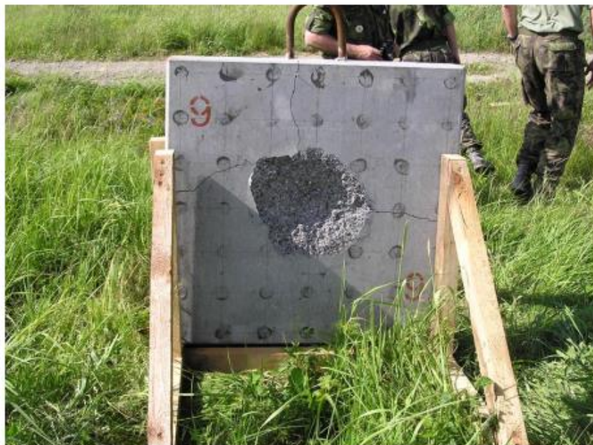
Slika 5-11. Prikaz nearmirane betonske ploče razreda C70/85 nakon djelovanja 70 g plastičnog eksploziva (Štoller i Dvorak, 2017)
