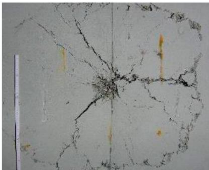
Slika 5-4. Prikaz neopterećene strane betonske ploče izrađene od betona sa vlaknima (Zircher i dr., 2017)
