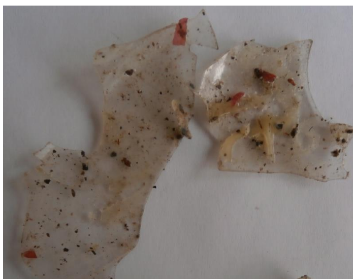
Slika 3-23. Parafin zaostao na plastici
