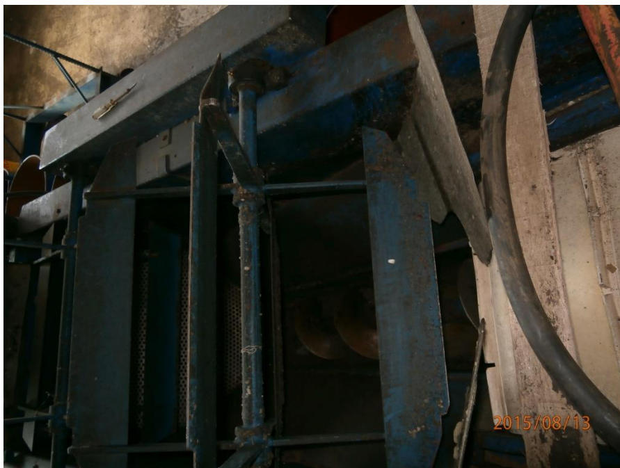
Slika 5-7. Prikaz komore sa spiralnim transporterom i rotirajućim lopaticama
