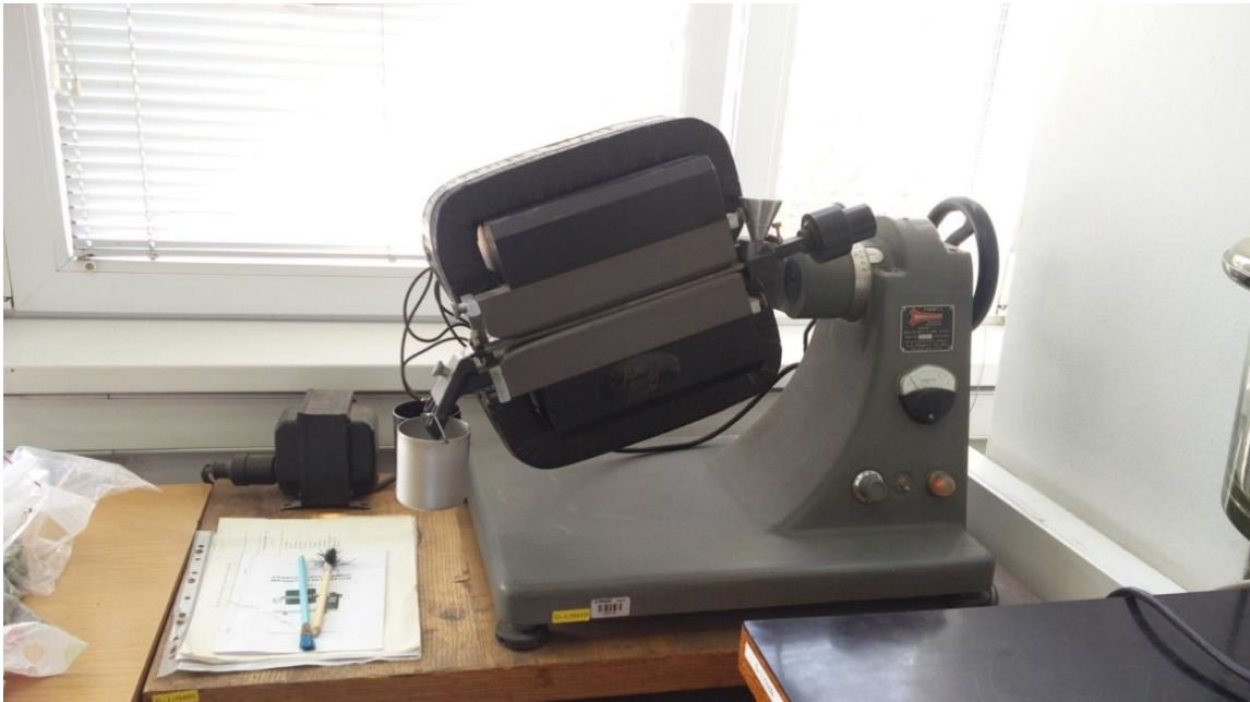
Slika 4-6. Frantzov magnetski izodinamski separator u laboratoriju Zavoda za mineralogiju, petrologiju i mineralne sirovine (foto: Ana Kamenski).
