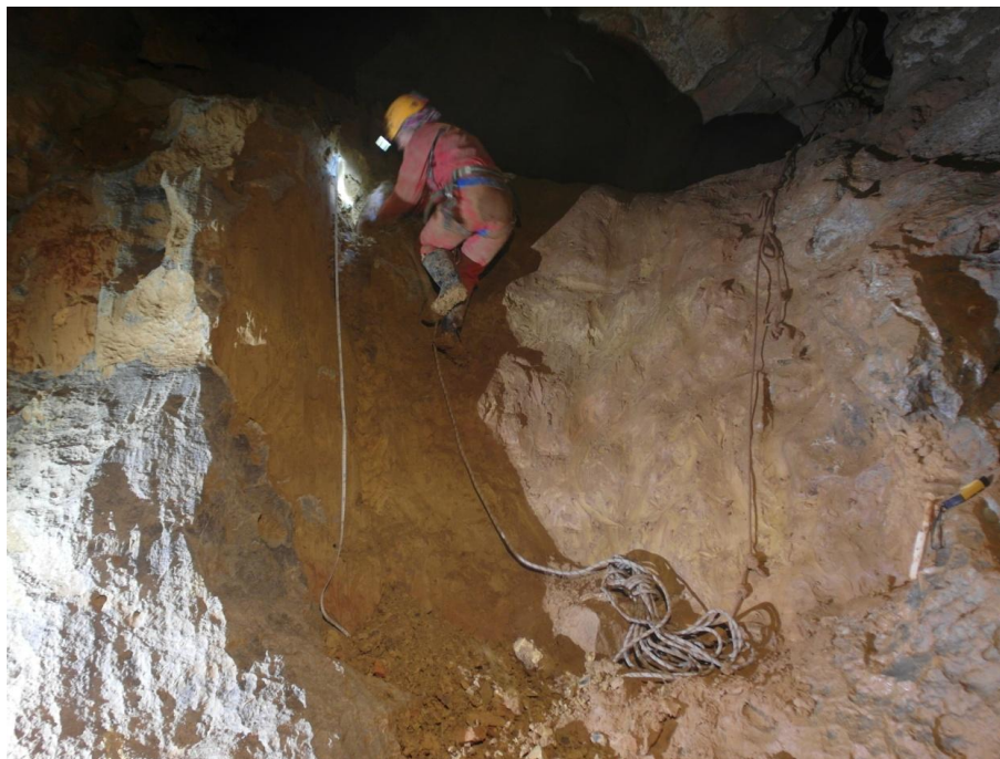
Slika 5-3. Registriranje magnetskog susceptibiliteta na profilu SL1 u Slovačkoj jami (foto: Dalibor Paar).
