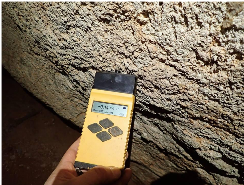
Slika 4-2. Uređaj Kappameter KM-7 mjeri magnetski susceptibilitet u Jamskom sustavu Kita Gačešina-Dražanova puhaljka (foto: Dalibor Paar).
