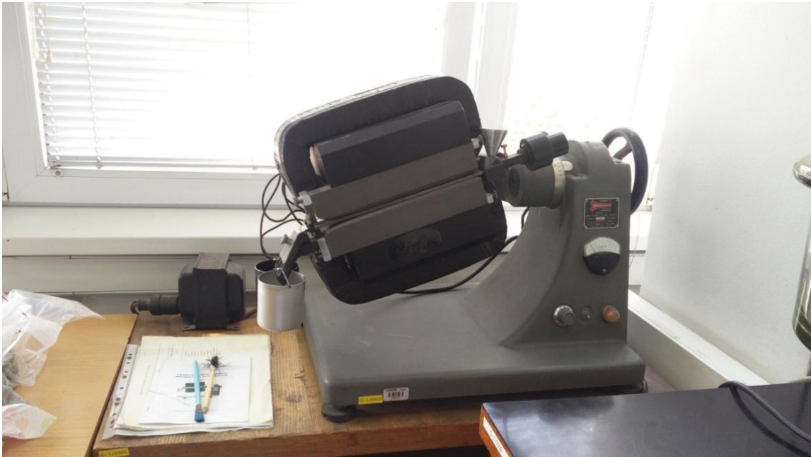
Slika 4-6. Frantzov magnetski izodinamski separator u laboratoriju Zavoda za mineralogiju, petrologiju i mineralne sirovine (foto: Ana Kamenski).
