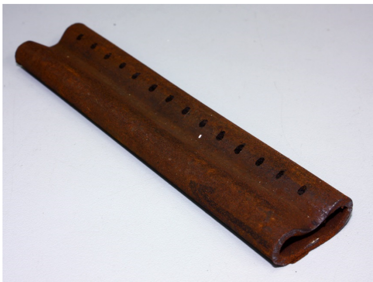
Slika 4-17. Ispitna cijev nakon deformacije.
