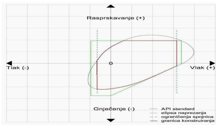
Slika 2. 2. Elipsa napreznja konstruiranja opreme (Norsok Standard D-010, 2013.)
