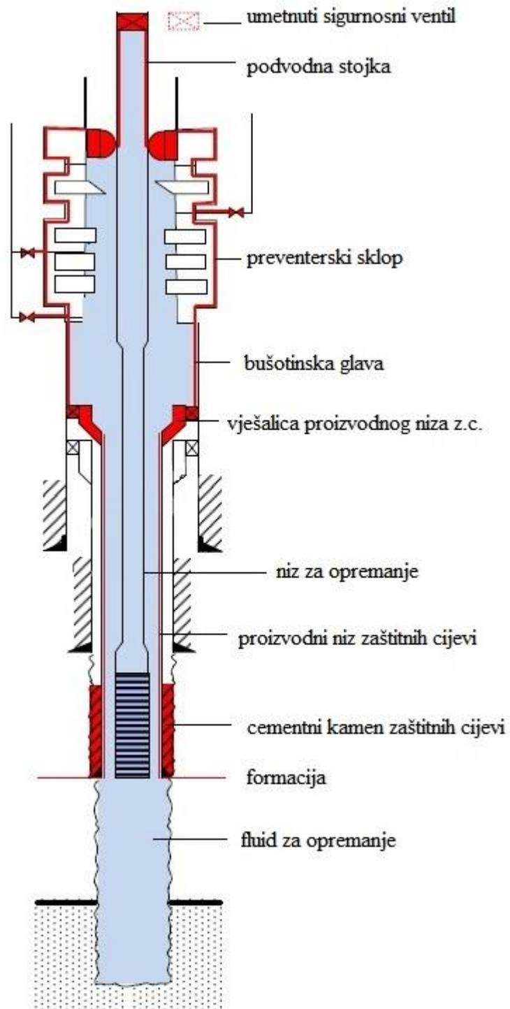
Slika 3. 3. Grafički prikaz barijera tijekom opremanja; spuštanje alata kroz BOP (Norsok Standard D-010, 2013.)
