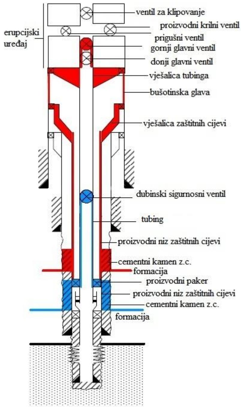
Slika 3.5. Grafički prikaz barijera tijekom opremanja; opremljena proizvodna bušotina (Norsok Standard D-010, 2013.)
