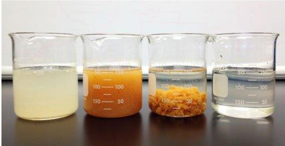
Slika 2-7 Koagulacija/flokulacija (Ecologix environmental system, 2018 )
