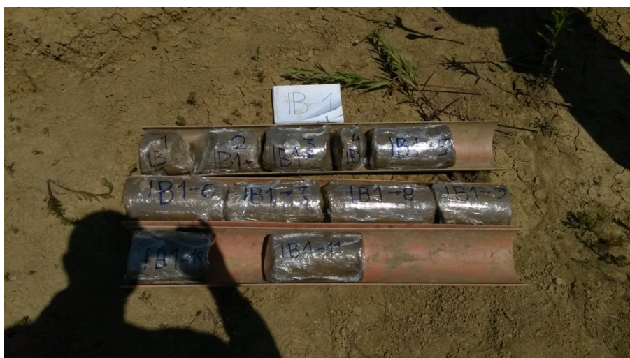
Slika 7.24 Izvađena jezgra glinenog tla iz jezgrene cijevi na EP Cukavec II
