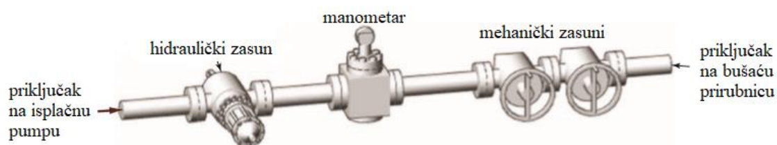
Slika 3-2. Vod za gušenje bušotine za radni tlak od 34,5 MPa (5 000 psi) (API Specification 16C, 2015)
