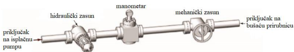
Slika 3-1. Vod za gušenje bušotine za radni tlak od 13,8/20,7 MPa (2 000/3 000 psi) (API Specification 16C, 2015)
