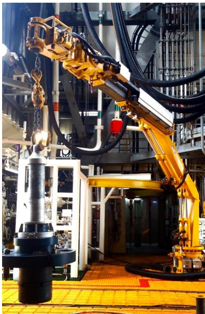
Slika 4-6. Manipulatorska ruka UHT 1 200 tvrtke NOV (Nov, 2016)
