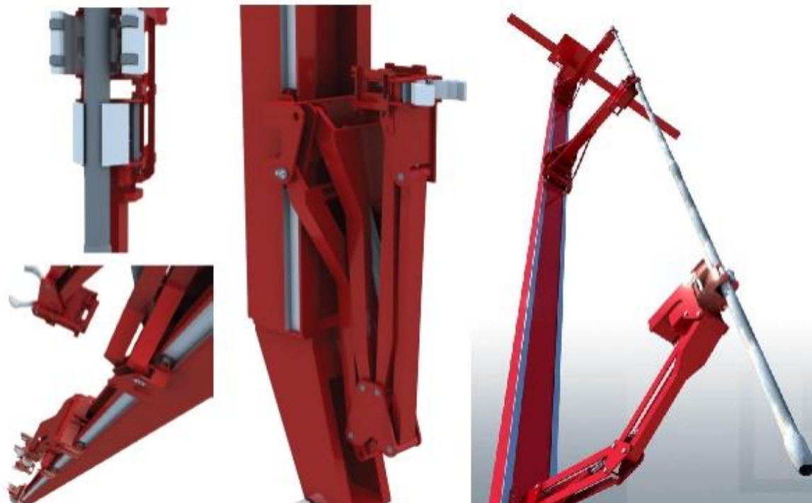
Slika 4-7. Vertikalni manipulator tvrtke Aker Solutions (Aker Solutions, 2012)
