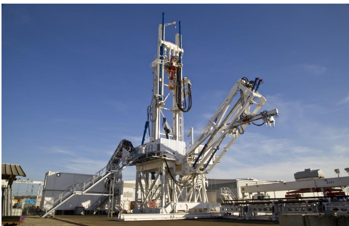
Slika 4-3. Automatizirani sustav s mehaničkom rukom Terra Invader 350 (Nce, 2014)
