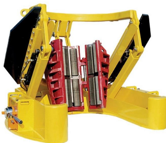
Slika 4-10. Sustav automatiziranih klinova s okvirom (Nov, 2010)
