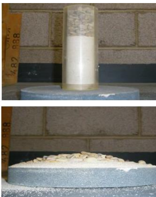
Slika 2-4. Cilindar prije i poslije podizanja sa slojem pijeska 10,0 cm, mala brzina podizanja, hrapava podloga (Liu, 2011)
