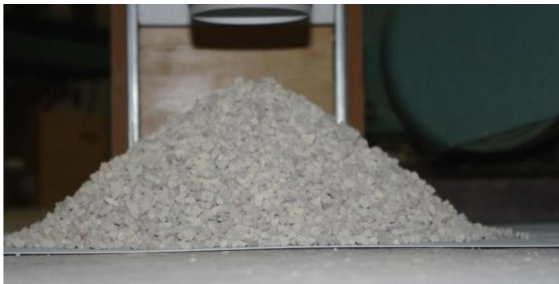
Slika 5-2 Mjerenje kuta sipanja na uzorku dolomitnog agregata
