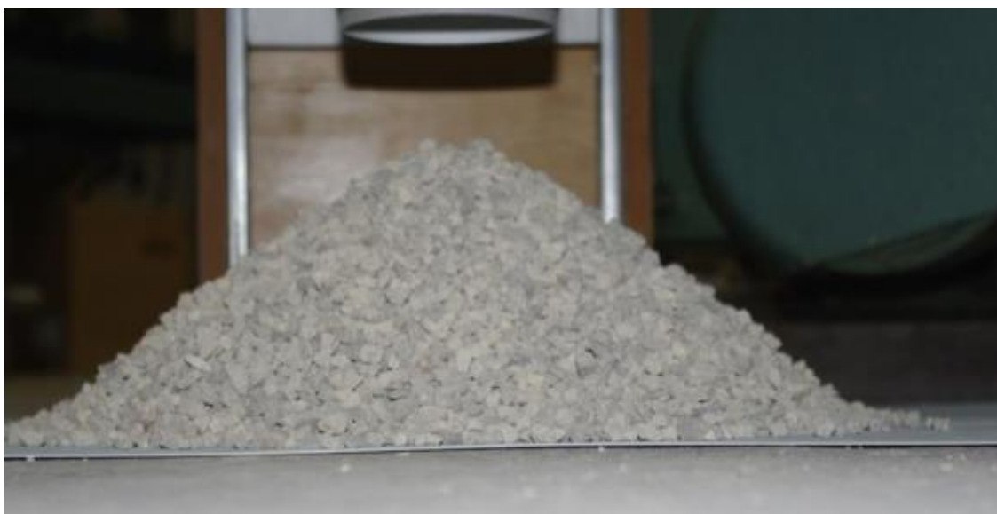
Slika 5-2 Mjerenje kuta sipanja na uzorku dolomitnog agregata
