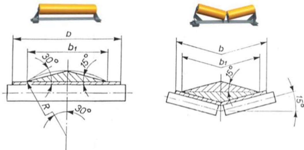
Slika 2-3 Poprečni presjek transporterja s beskonačnom trakom (Korman, n.d. )
