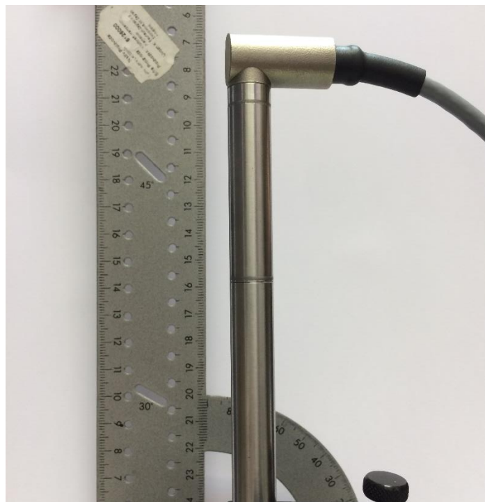
Slika 3-8 Okomitost pretvornika pomaka HBM WA10
