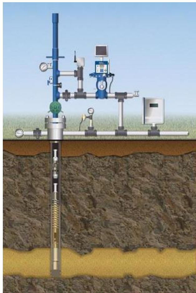
Slika 3-1. Prikaz bušotine opremljene za rad klipnim liftom (Guo et al., 2007)
