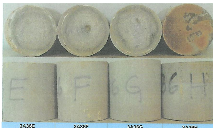
Slika 4-24. Uzorak cementnog kamena dobiven očvršćavanjem cementne kaše 3A36 nakon izlaganja vodenoj kupki zasićenoj s ugljikovim dioksidom
