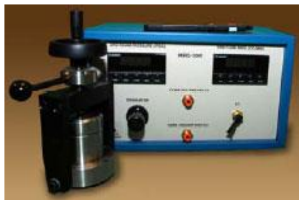
Slika 4-4. Plinski permeametar tvrtke Core Laboratories (CoreLab, 2019)
