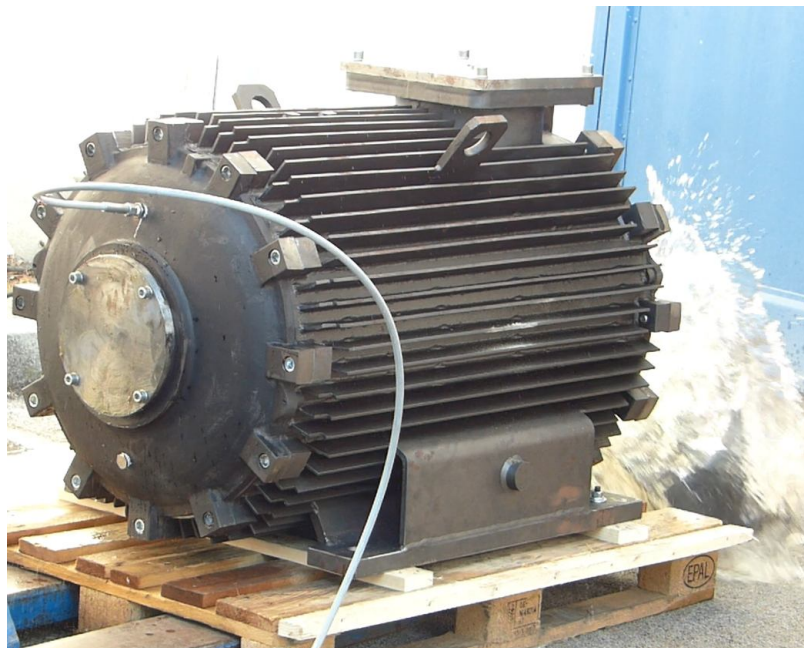
Slika 3-3 Elektromotor podvrgnut statičkom ispitivanju tijekom podizanja tlaka. (Ex agencija, 2018)
