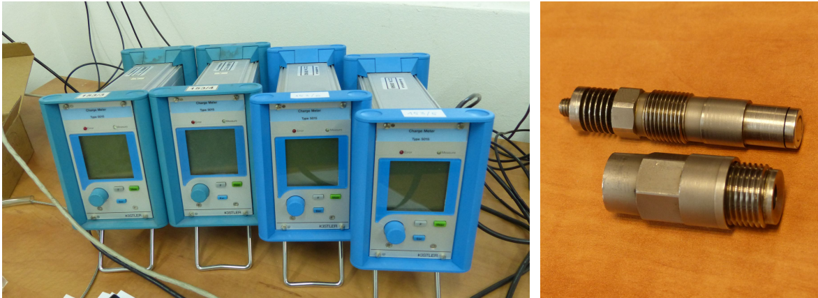
Slika 3-13 a) Pojačala signala (lijevo) i 3-13 b) Senzori tlaka (desno) (Ex Agencija, 2018)
