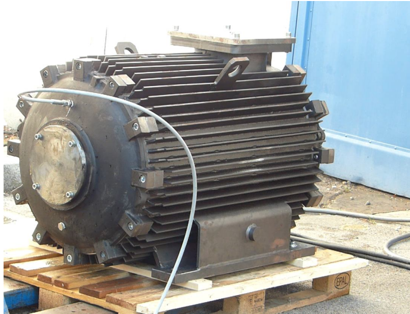
Slika 3-3 Elektromotor podvrgnut statičkom ispitivanju tijekom podizanja tlaka. (Ex agencija, 2018)
