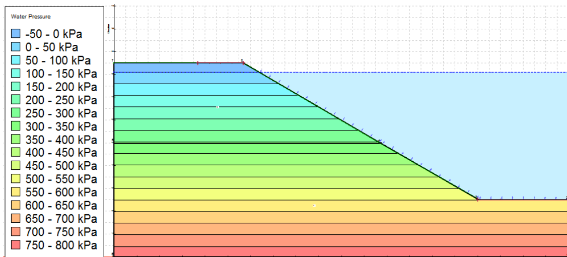
Slika 4-3 Raspodjela poreznih tlakova na kosini
