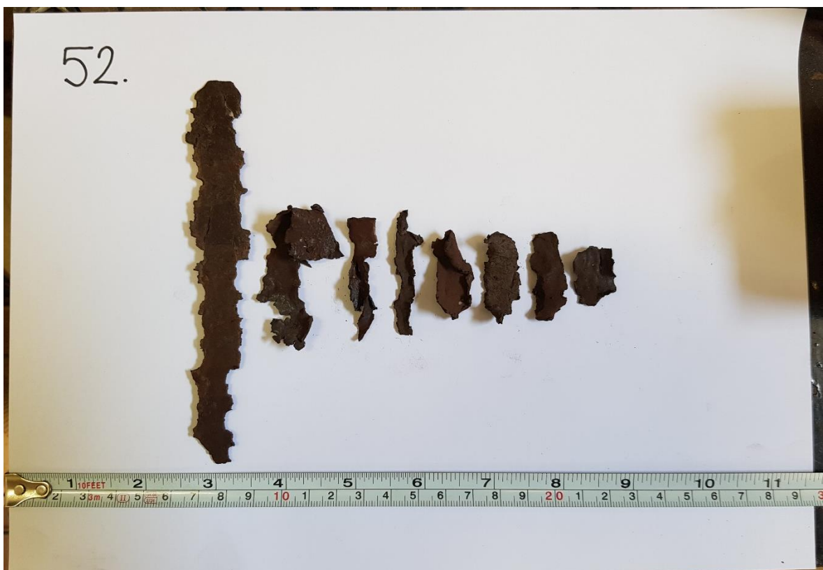
Slika 4-11. Krhotine cijevi broj 52 (63/45 \mu\text{m} , 5%)
