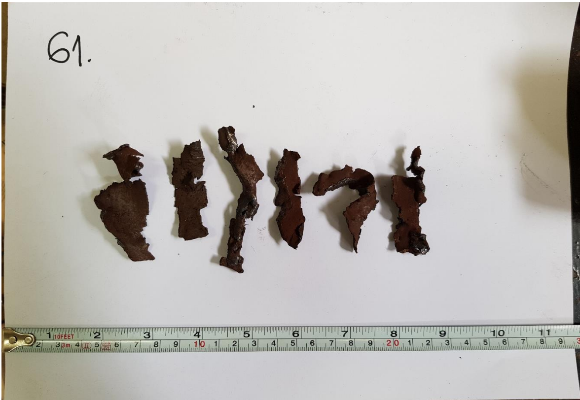
Slika 4-14. Krhotine cijevi broj 61 (90/75 \mu\text{m} , 2%)
