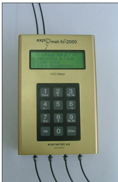
Slika 3-6. Elektronički sat Explomet-Fo-2000.
