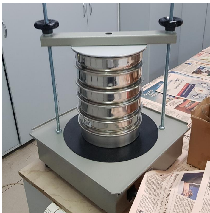
Slika 3-2. Treskalica s postavljenim sitima
