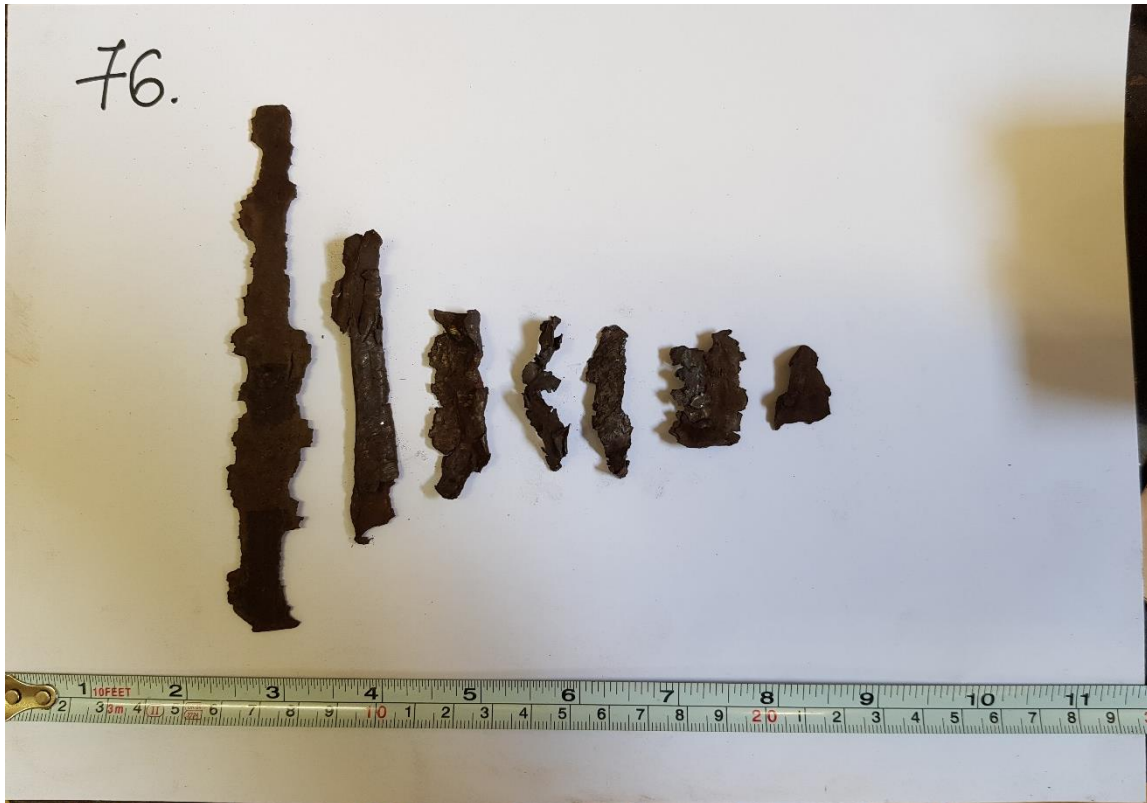
Slika 4-16. Krhotine cijevi broj 76 (90/75 µm, 5%)
