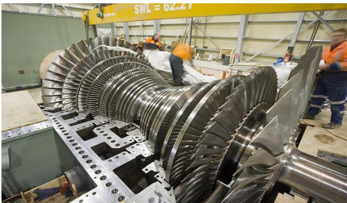
Slika 2-1. Parna turbina sekundarnog fluida (Flickr, 2019.)
