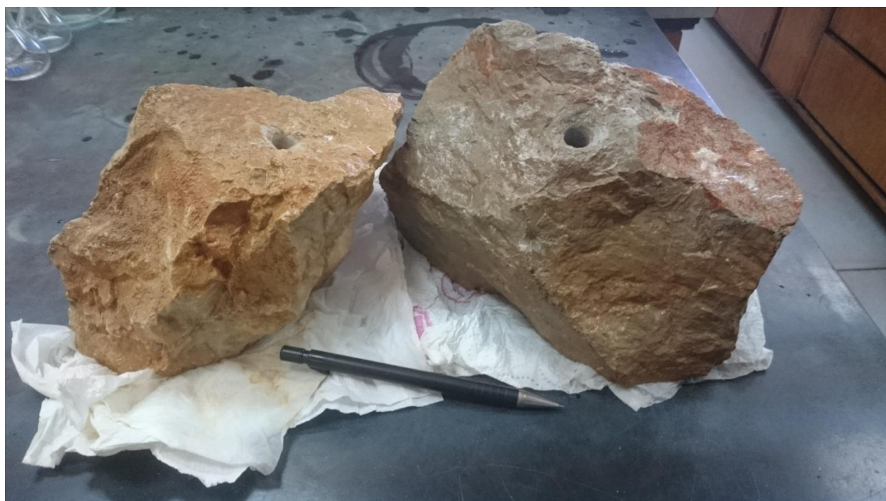
Slika 3-2: Uzorci vapnenca s probušenim rupama za termalni senzor
