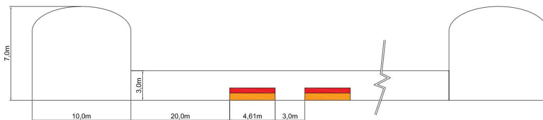
Slika 3-12 Prikaz rasporeda spremnika u odlagališnom tunelu za Koncept-4 (prema: NAGRA, 2009 i 2002)
