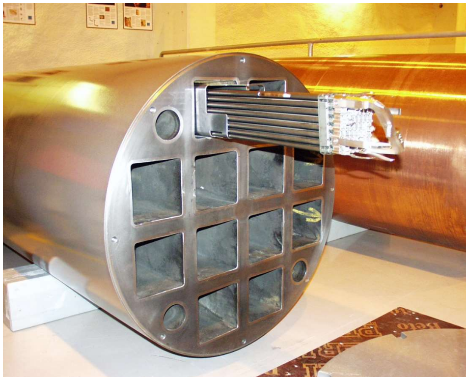
Slika 3-16 Insert – unutrašnja struktura od lijevanog željeza, s jednim ubačenim gorivnim elementom, finski koncept (POSIVA), (izvor: prof.dr.sc. Ivan Vrkljan, privatna zbirka).
