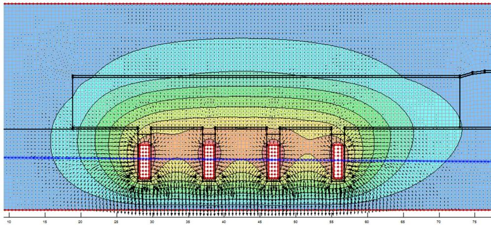
**Slika 4-35** Profil (horizontalni kroz sredine spremnika naznačen modrom bojom s karakterističnim točkama) po kojem su prikazane promjene temperatura kroz vrijeme, dane grafovima na slici 4-36.
