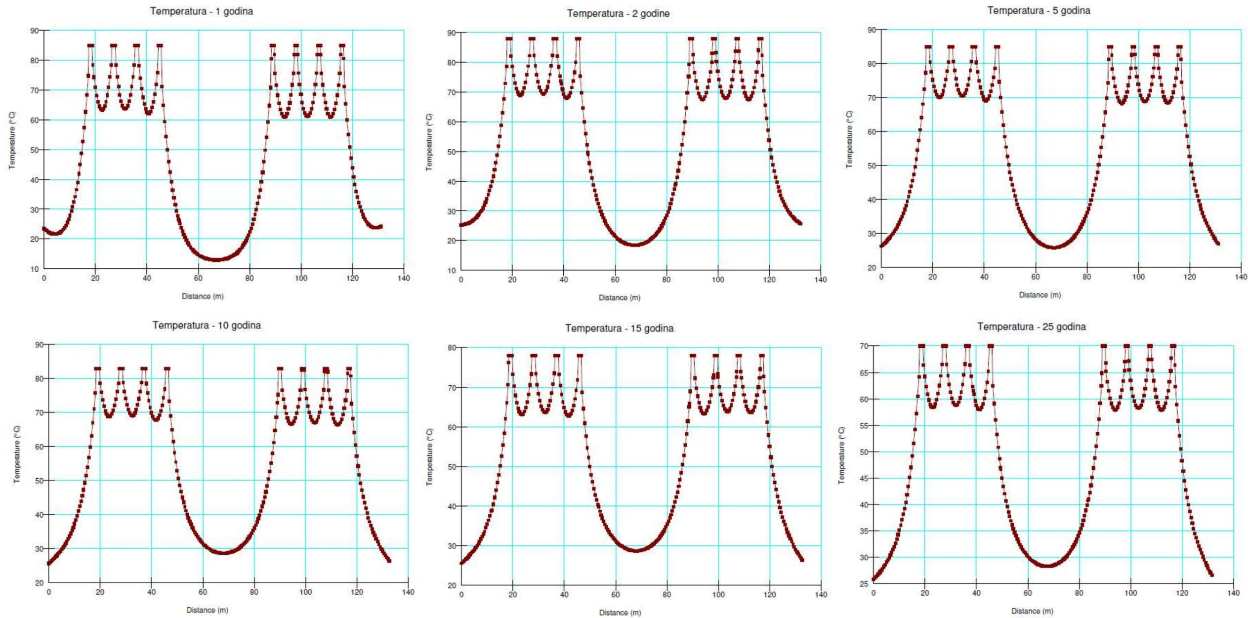
Slika 4-36 Promjene temperatura po profilu (slika 5-35), kroz vrijeme.
