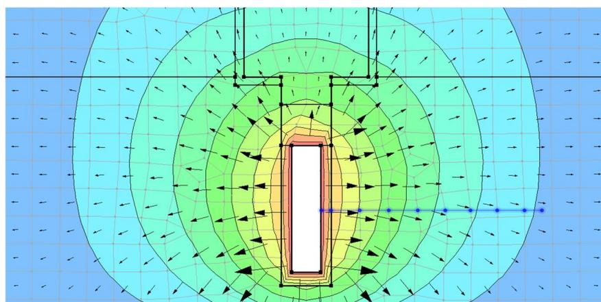
**Slika 4-29** Profil (horizontalni s početkom na SREDINI spremnika!, naznačen modrom bojom s karakterističnim točkama) po kojem su prikazane promjene temperatura kroz vrijeme, dane grafovima na slici 4-30.
