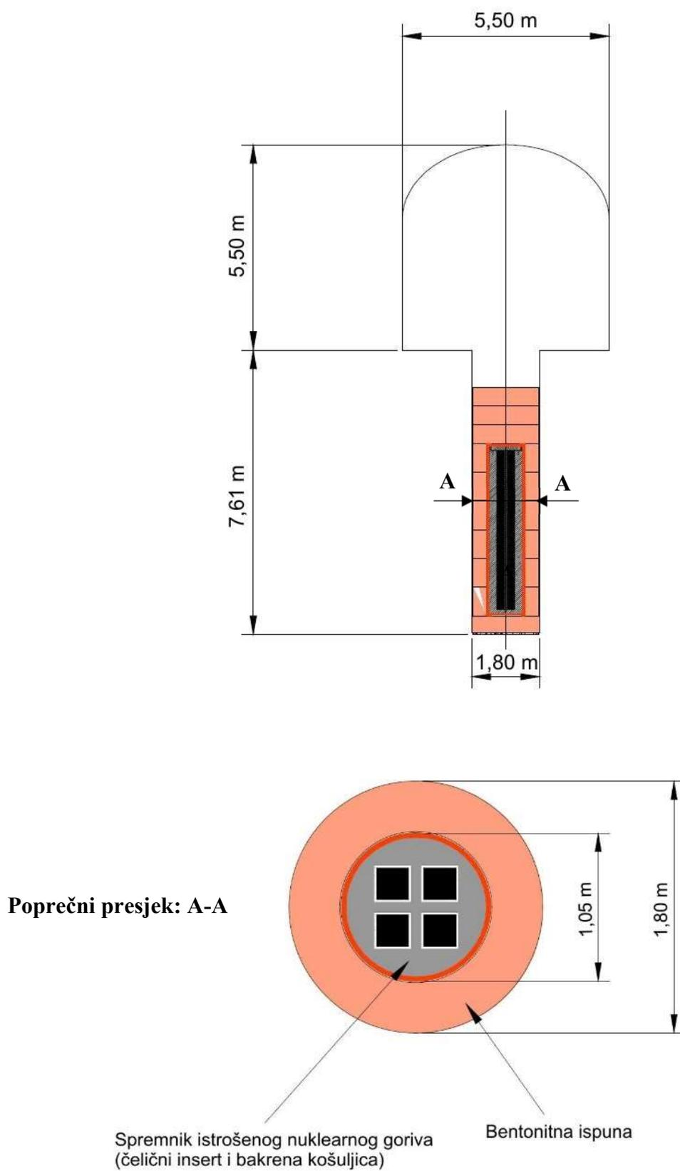
**Slika 3-7** Poprečni presjek kroz hodnik i bušotinu za odlaganje (gore) i detalj – poprečni presjek kroz bušotinu i spremnik (dolje) (prema: ARAO, 2019).
