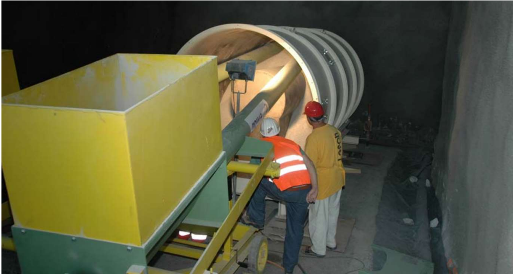
Slika 3-22 Testiranje tehnologije zapunjavanja prostora oko spremnika bentonitnim peletima (Fries i dr., 2008)
