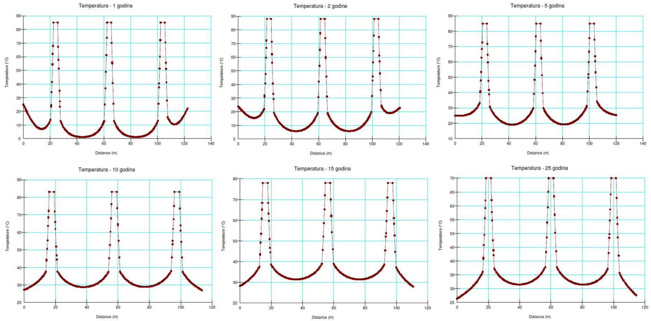
Slika 4-54 Promjene temperatura po profilu (slika 4-53), kroz vrijeme.
