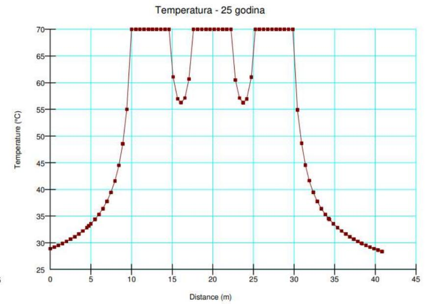
Slika 4-58 Promjene temperatura po profilu (slika 4-57), kroz vrijeme.
