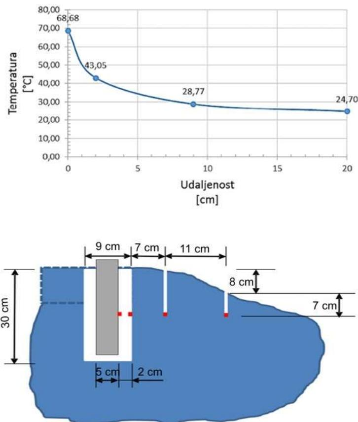
**Slika 5-3** Skica eksperimenta sa zagrijavanjem magmatske stijene (simulacija odlaganja spremnika s ING-om) električnim grijačem (Nogolica, 2015). Senzori za temperaturu (crveni kvadratići) odgovaraju položajem vrijednostima očitane srednje temperature na grafu iznad. Prostor između grijača (sivo) i stijene (plavo) bio je ispunjen suhim zbijenim bentonitom.
