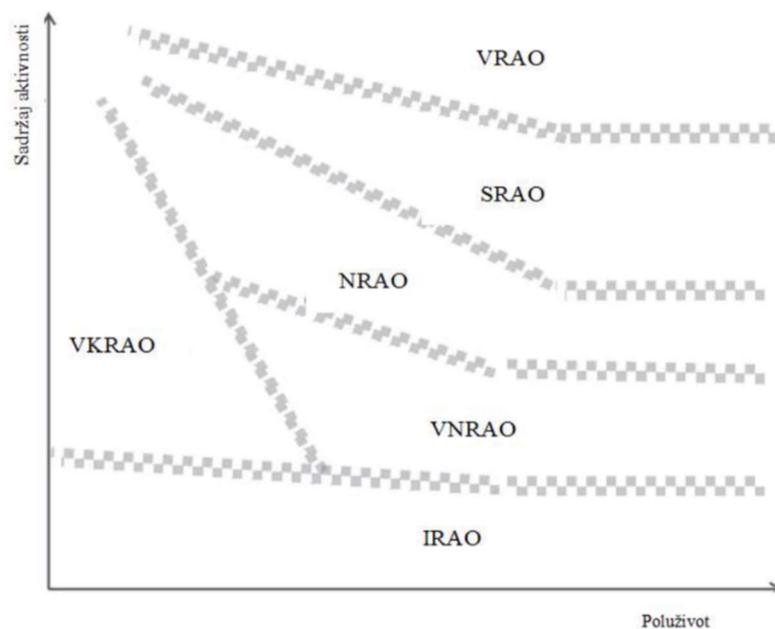
**Slika 2-12** Shema klasifikacije radioaktivnog otpada (IAEA, 2009a): IRAO - izuzeti radioaktivni otpad (EW – exempt waste); VKRAO - vrlo kratkoživi radioaktivni otpad (VSLW – very short lived waste); VNRAO - vrlo niskoradioaktivni otpad (VLLW – very low level waste); NRAO - niskoradioaktivni otpad (LLW – low level waste); SRAO - srednje radioaktivni otpad - (ILW – intermediate level waste); VRAO - visoko radioaktivni otpad - (HLW – high level waste).
