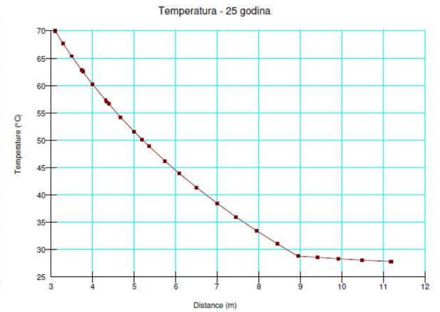
Slika 4-51 Promjene temperatura po profilu (slika 4-50), kroz vrijeme.
