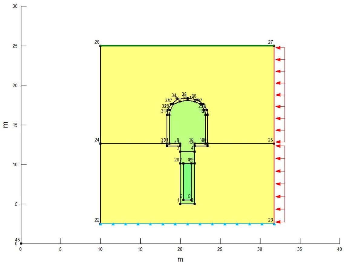
**Slika 4-18** Osnovni model, s postavljenim regijama materijala i graničnim uvjetima (tok s desna na lijevo i nepropusna podloga).
