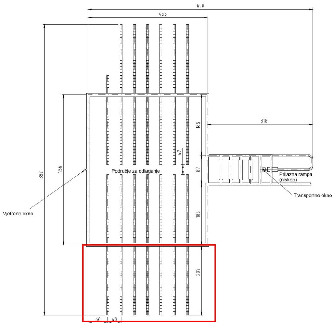
**Slika 5-1** Crvenim pravokutnikom označeno područje jednog panela za koji se pokušalo provesti simulaciju, s obzirom da za cijelu površinu odlagališta (sva četiri panela) model nije bio provediv.
