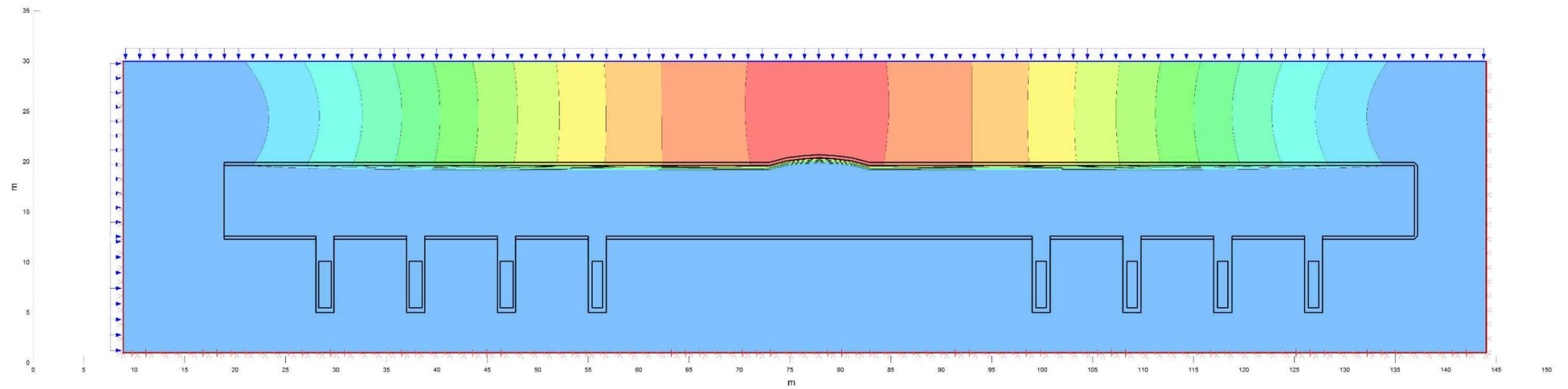
Slika 4-17 Pomaci na modelu kroz presjek uzduž odlagališnog tunela u fazi zapunjenih odlagališnih tunela.
