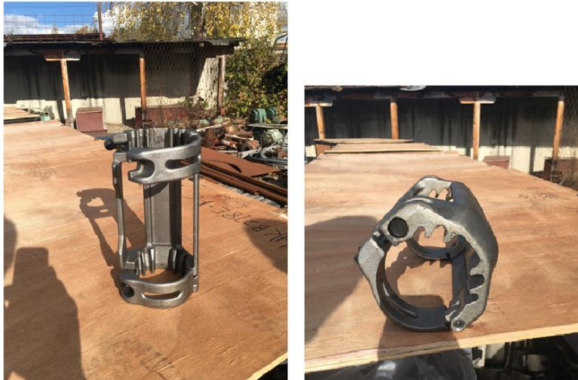
Slika 11-8. Metalna obujmica voda za doziranje
