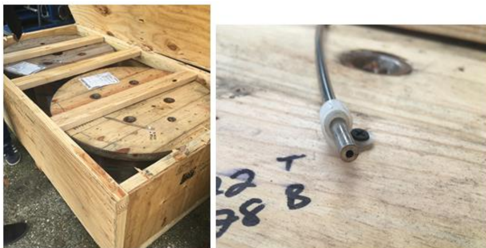
Slika 11-7. Vod za doziranje kemikalija namotan na bubanj
