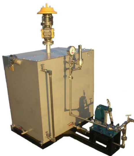
Slika 10-1. Dozirni uređaj za DUS sa svom opremom (DUWAR d.o.o., 2019)
