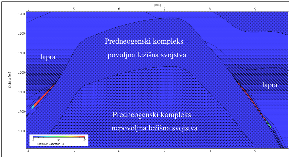
Slika 8-11. 2D prikaz „nerealne akumulacije“ u dijelu gdje vukovarska formacija isklinjava.
