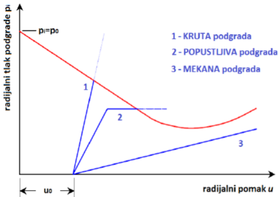
Slika 6-11 Dijagram radijalnog pomaka krute, popustljive i mekane podgrade (Tunelogradnja, 2009.)
