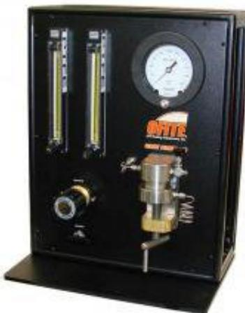
Slika 3-5. Uređaj za mjerena propusnosti cementnog kama (OFI Testing Equipment, 2019 (e))
