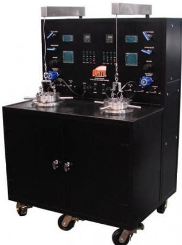
Slika 3-3. Autoklav – komora za stvrdnjavanje (OFT Testing Equipment, 2019 (c))
