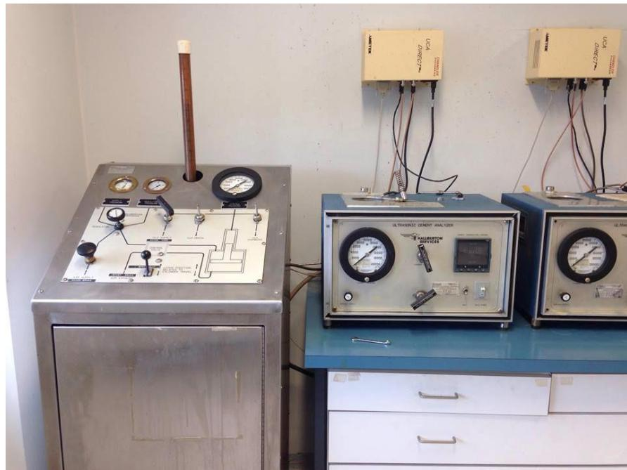
Slika 5-10. Ultrazvučni analizator (UCA) (Šeb, 2018)
