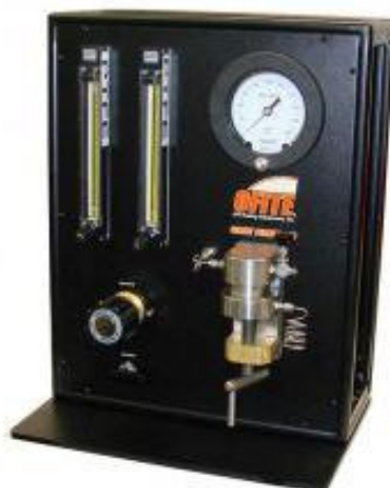
Slika 3-5. Uređaj za mjerenja propusnosti cementnog kamena (OFI Testing Equipment, 2019 (e))
