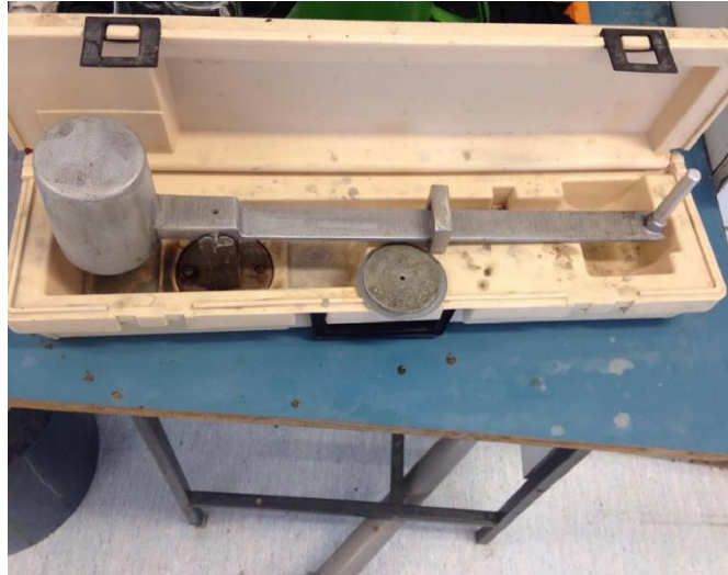
Slika 5-2. Korištena vaga za isplaku (Šeb, 2018)
