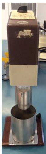
Slika 5-4. Viskozimetar kompanije OFITE Model 800 (Šeb, 2018)
