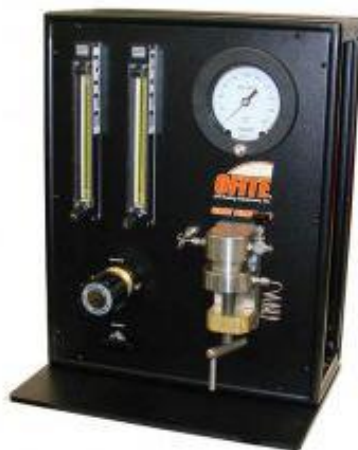
Slika 3-5. Uređaj za mjerenja propusnosti cementnog kamena (OFI Testing Equipment, 2019 (e))
