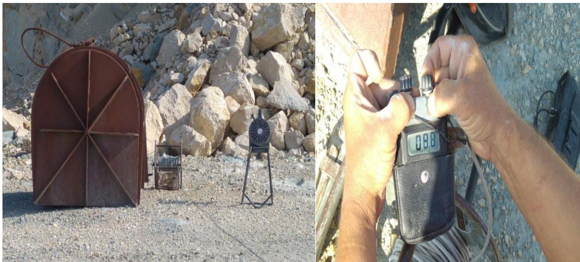
Slika 5-3 Sklonište za palitelja mina i mjerjenje otpora
