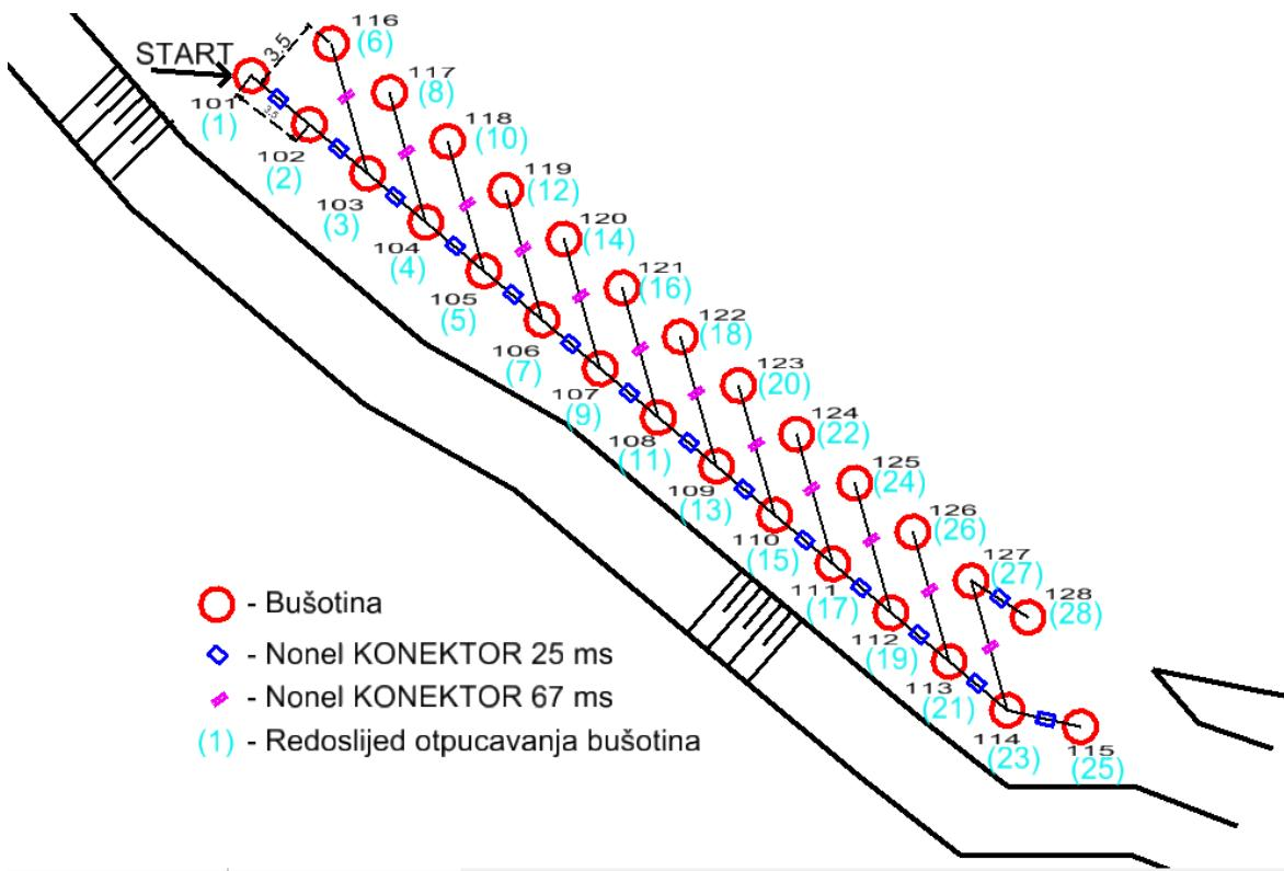
Slika 3-1 Plan bušenja s usporenjima minskih bušotina
