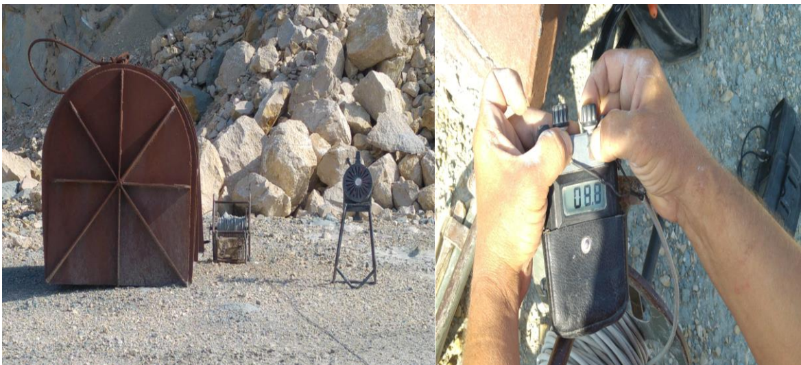
Slika 5-3 Sklonište za palitelj mina i mjerenje otpora
