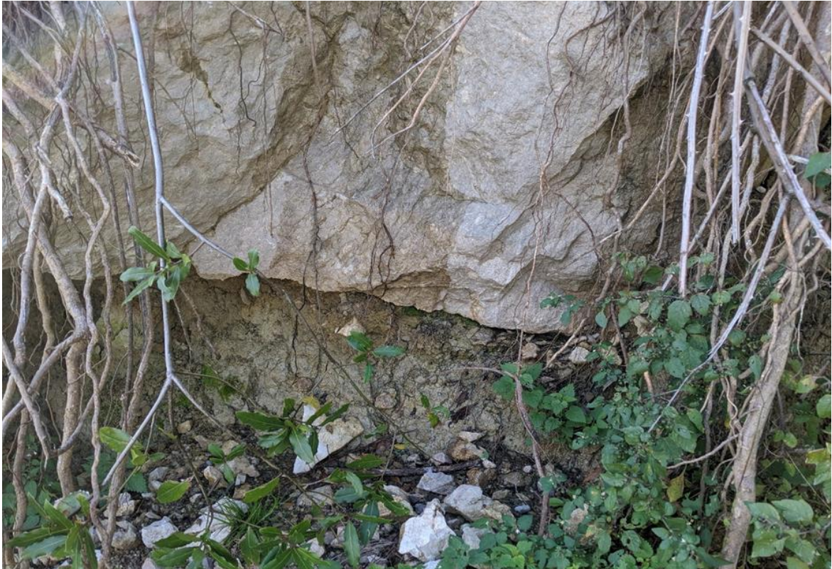
Slika 3.3. Fotografija prikazuje kontakta numulitne breče u krovini i srednje trošnog lapora u podini u tijelu klizišta (fotografirano 4.11.2019).
