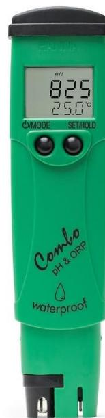
*Slika 4.2. Instrument korišten za određivanje pH i ORP-a*
