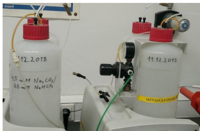
Slika 4.4. Mobilna faza u spremnicima volumena 2l
