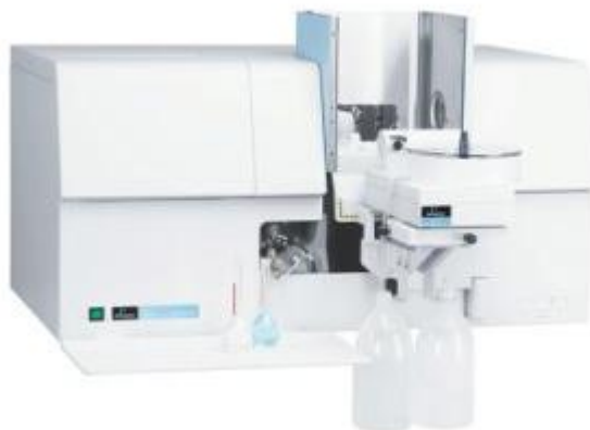
Slika 3. 1. Atomski apsorpcijski spektrometar AAS 700 (izvor: http://www.speciation.net/Database/Instruments/PerkinElmer-Inc/AAnalyst-700-;i8 )
