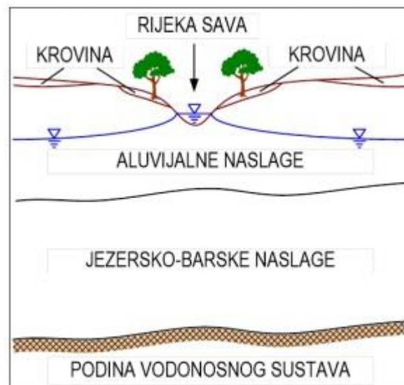
Slika 2. 3. Shematski profil zagrebačkog vodonosnog sustava (Posavec, 2006).
