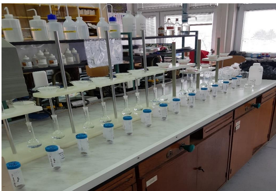
Slika 3.5. Procedura prilikom izvođenja eksperimenta sorpcije
