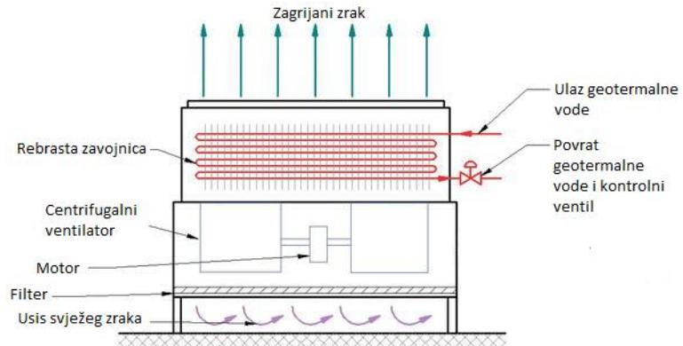
**Slika 6-2.** Shema rada ventilokonvektora (Seyam, 2018)
