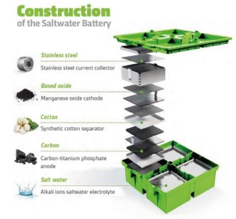
Slika 4-12. Konstrukcija natrij-ionske baterije (Izvor: GreenRock)
