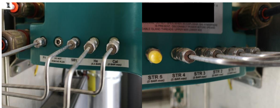
Slika 5-6. Injektori plina nosioca, kalibracijskog te uzorkovanog plina
