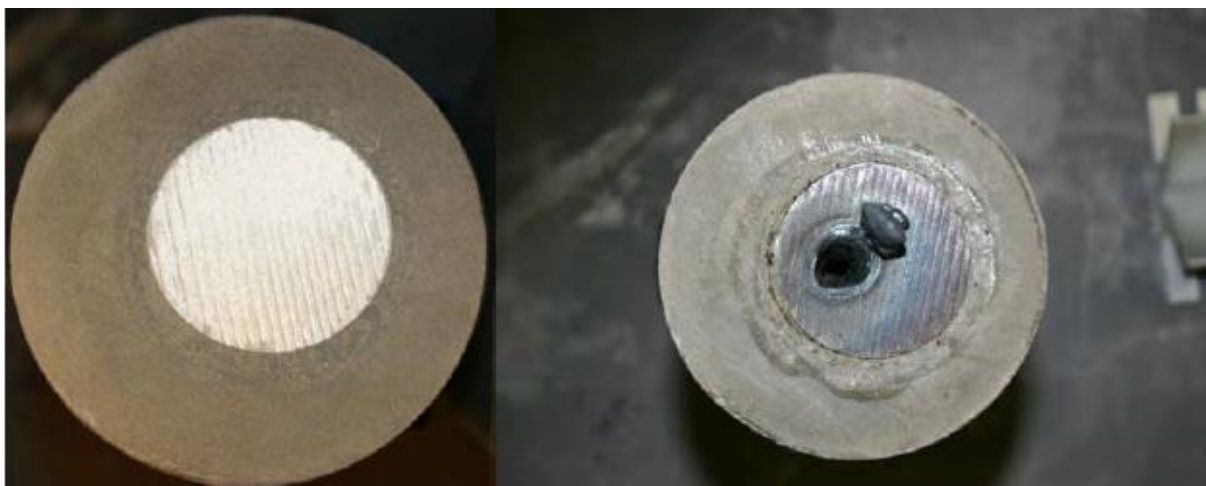
Slika 5-4. Rezultati laboratorijskih perforiranja uzoraka stijene uz simuliranje postojanja čelične zaštitne cijevi i cementnog kamena (Gahan et al., 2005)
