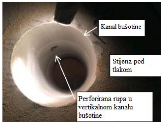
Slika 6-3. In-situ perforacija u vertikalnom kanalu bušotine (Batarseh et al., 2017)
