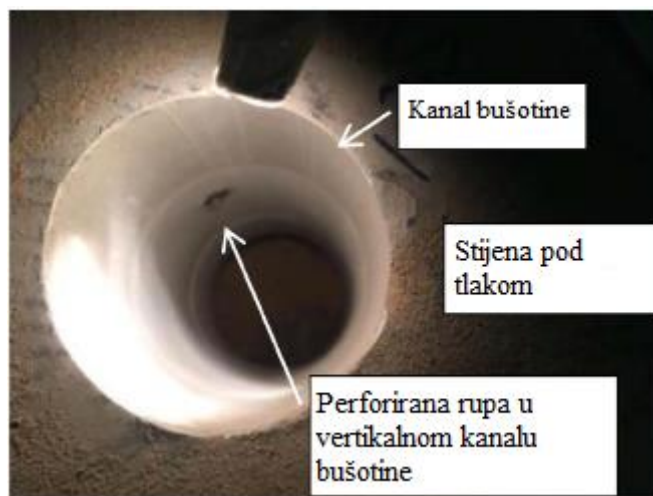
Slika 6-3. In-situ perforacija u vertikalnom kanalu bušotine (Batarseh et al., 2017)
