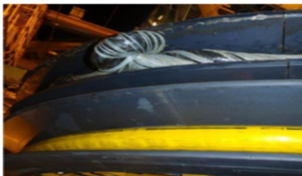
Slika 7-5. Uvijanje kontrolnog voda u sklopu za kontrolu vodova (Løver et al., 2015)
