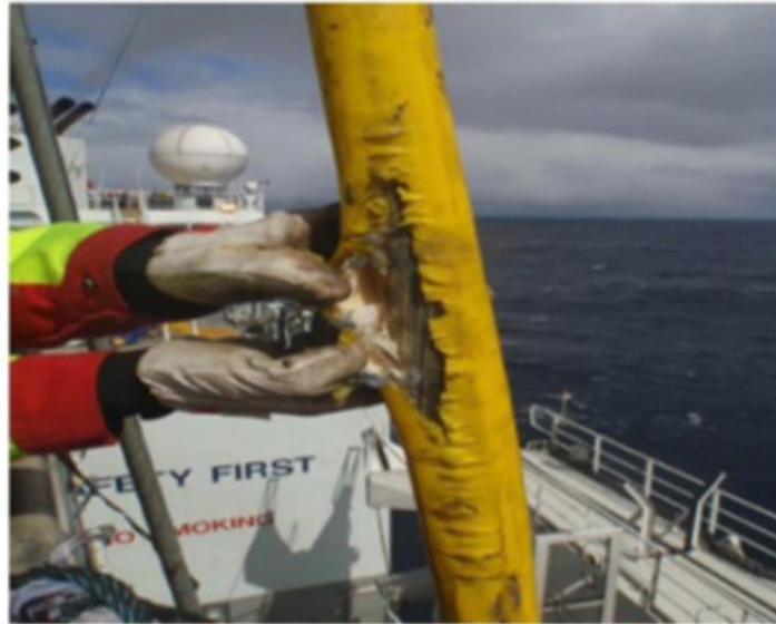
Slika 7-3. Oštećenje voda za prijenos kemikalija nastalo trošenjem materijala pri kontaktu voda s brodom(Løver et al., 2015)
