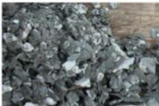
Slika 5-7. Krhotine kamenca nakon njegova uklanjanja iz proizvodnog niza (Karlsen et al.,2014)
