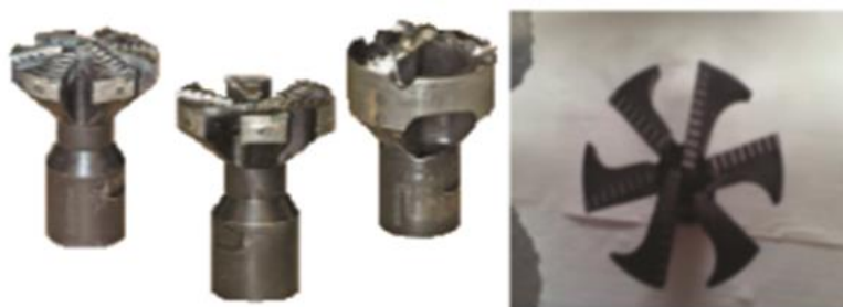
Slika 5-6. Dlijeta za uklanjanje kamenca, standardna (lijevo) i posebno dizajnirana (desno) (Skeie et al., 2011)
