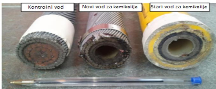
Slika 7-6. Vodovi korišteni pri izvođenju radova prije i nakon prilagodbe (Løver et al., 2015)
