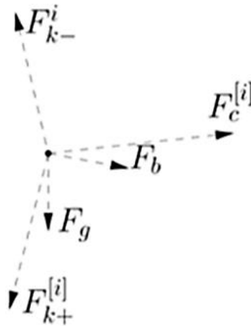
Slika 4-6. Prikaz smjera djelovanja pojedinih sila u svakoj točki kabela (Kjærsgaard-Rasmussen et al., 2011)
