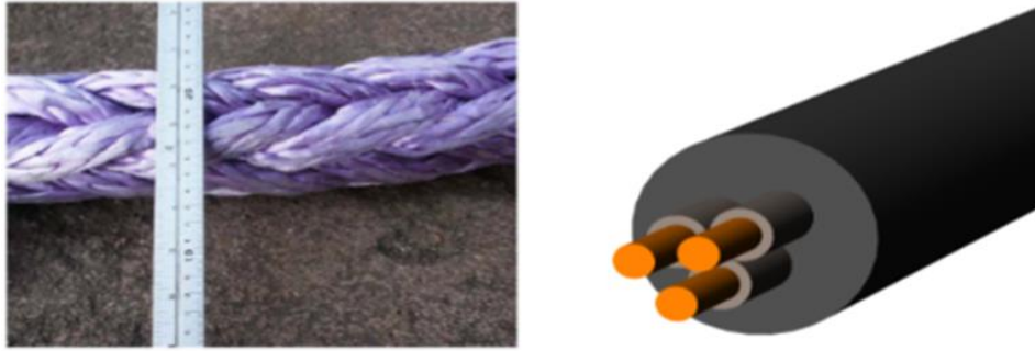
Slika 4-4. Pleteno uže od sintetičkih vlakana (lijevo) te poprečni presjek kompozitnog kabela (desno) (Mathiassen et al., 2008)
