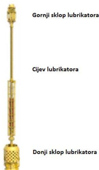
Slika 4-9. Sustav lubrikatora (Varne et al., 2017)
