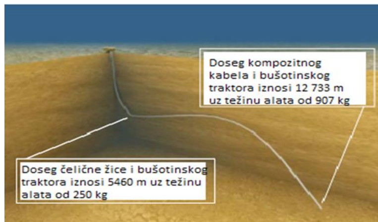
Slika 4-5. Usporedba dosega pri korištenju čelične žice promjera 11,1 mm i kompozitnog kabela promjera 9 mm (Munkerud et al., 2007)
