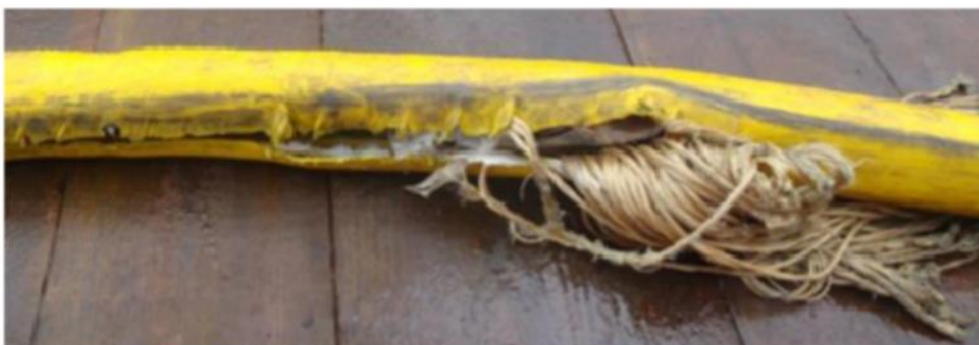
Slika 7-4. Prikaz ispucanih vlakana za prijenos opterećenja na vodu za prijenos kemikalija (Løver et al., 2015)
