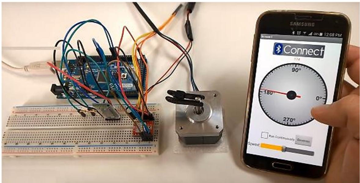
Slika 2-2 Primjena Arduina u mehatronici za upravljanje motorom preko aplikacije na pametnom telefonu (Dejan, *How to Mechatronics*, 2016)
