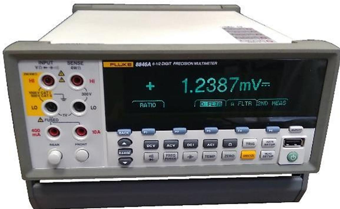
Slika 4-1 Precizni multimetar FLUKE 8846A
