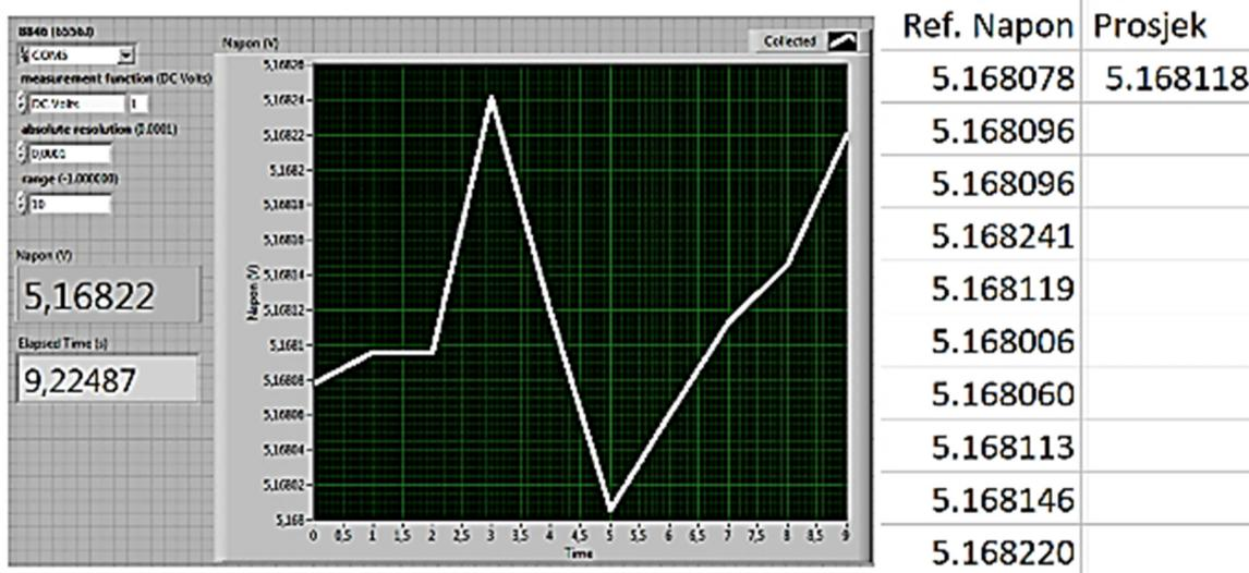
Slika 4-16 Određivanje referentnog napona Arduino platforme prije umjeravanja
