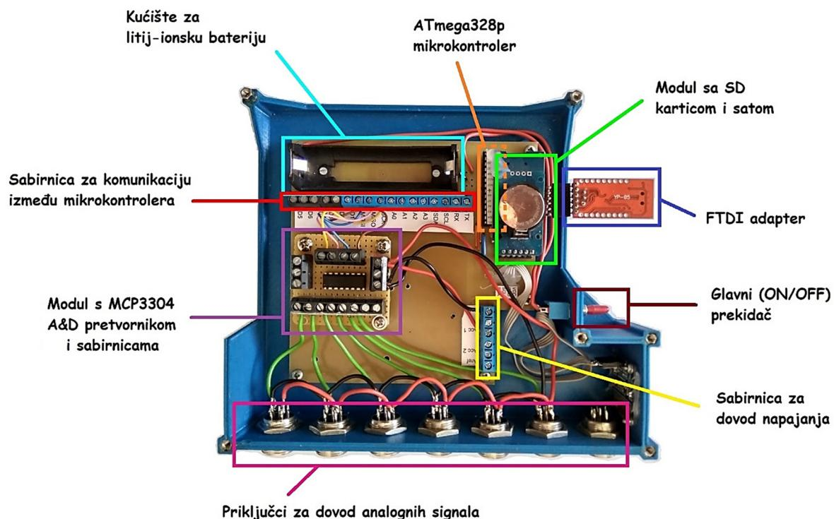
Slika 3-12 Shema *logger* uređaja s Arduino platformom
