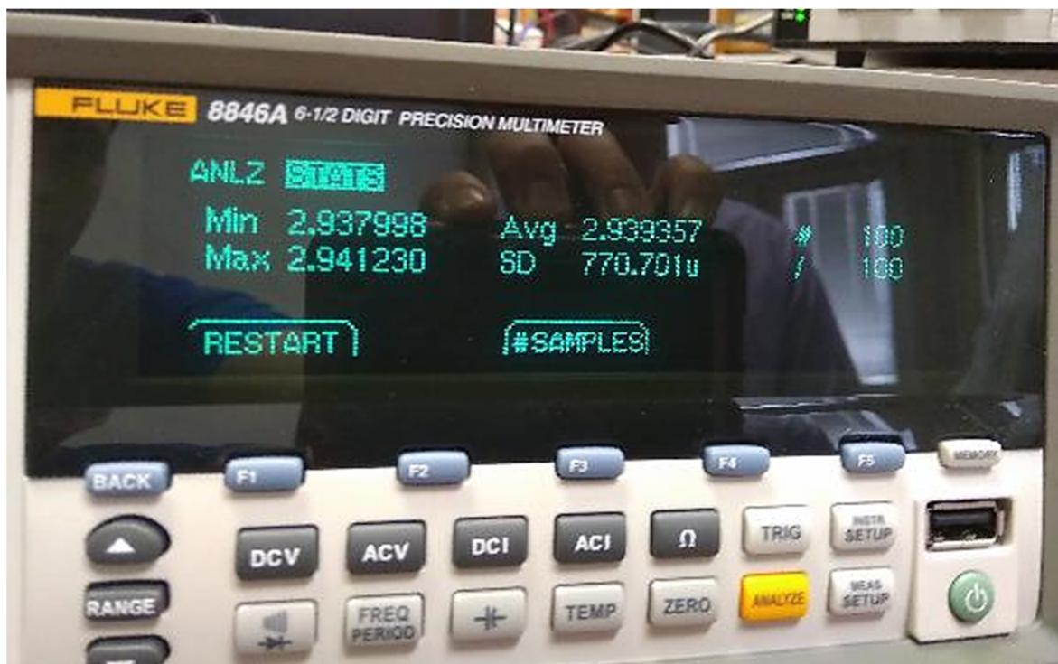
Slika 4-13 Određivanje standardne devijacije (SD) mjerena istosmjernog napona baterije
