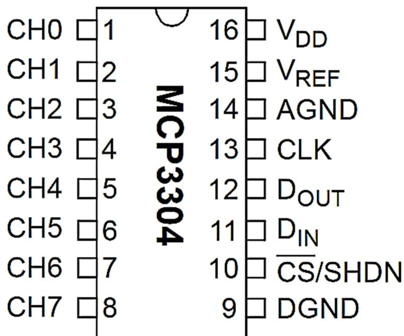
**Slika 3-13** Shematski prikaz ADC-a MCP3304 (*Microchip*, 2020)
