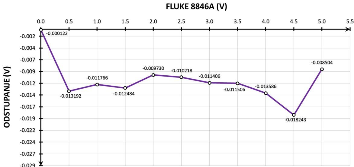
Slika 5-9 Odstupanje mjerena MCP3304 u odnosu na FLUKE za napajanje USB-portom
