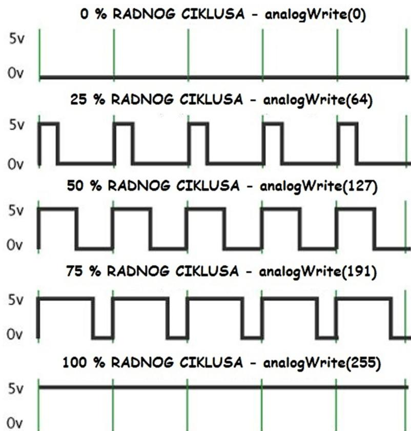
Slika 2-3 Modulacija širine pulsa (PWM) (Arduino, 2020b)
