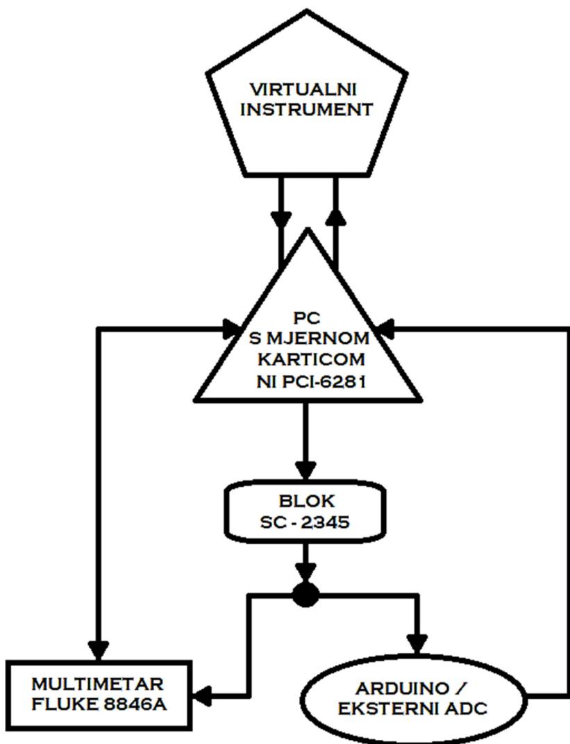
Slika 4-21 Blok dijagram spajanja uređaja za direktnu usporedbu mjerjenja
