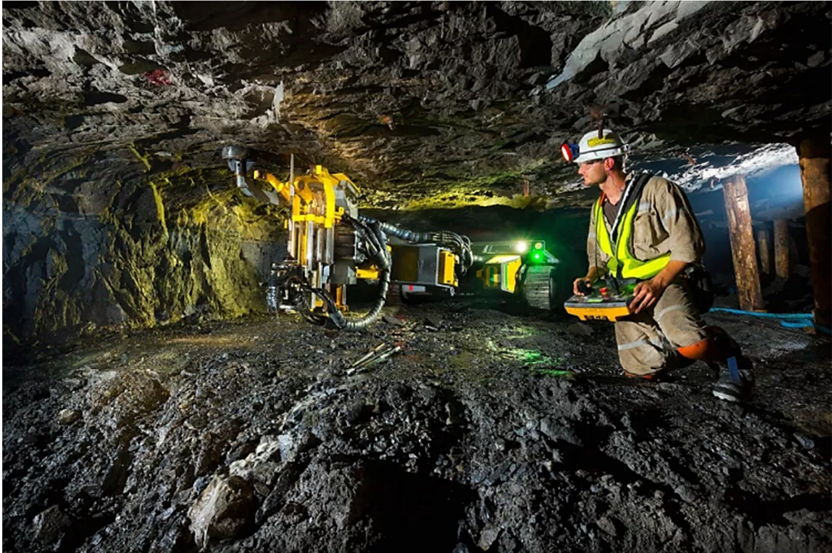
Slika 1-3 Daljinsko upravljanje strojem u opasnim uvjetima ( Alpha Technology , 2019)
