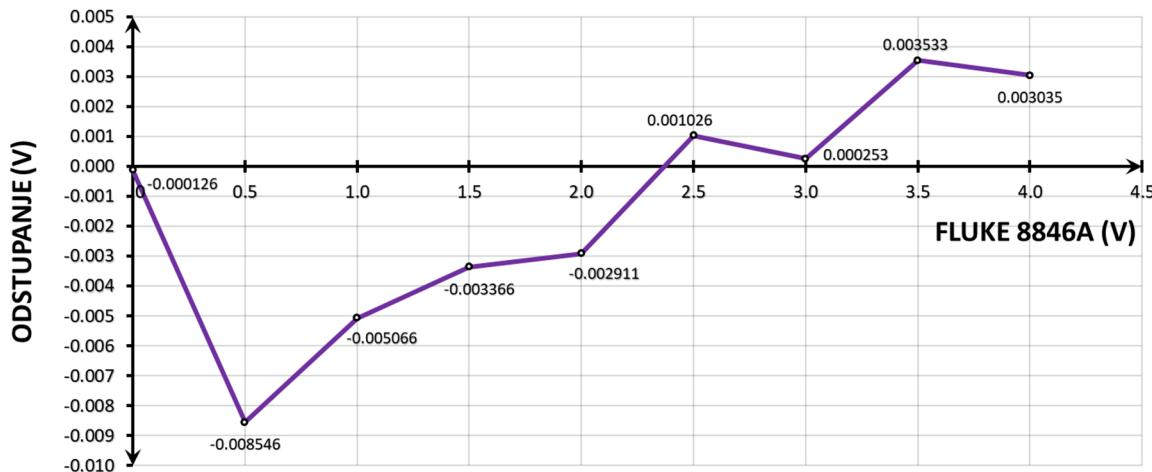
**Slika 5-6** Odstupanje mjerjenja Arduinom u odnosu na FLUKE za napajanje
