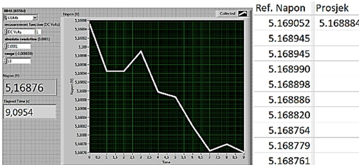
Slika 4-17 Određivanje referentnog napona Arduino platforme nakon umjeravanja
