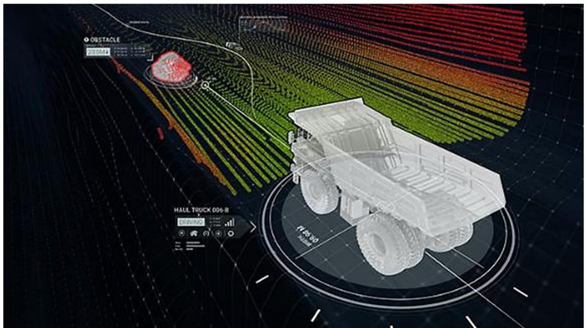
Slika 3-1 Princip funkciranja autonomnog transporta (*Asi Robots*, 2015a)
