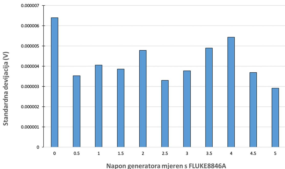
Slika 5-8 Rasipanje mjerena voltmetrom FLUKE za napajanje USB-priklučkom za MCP
