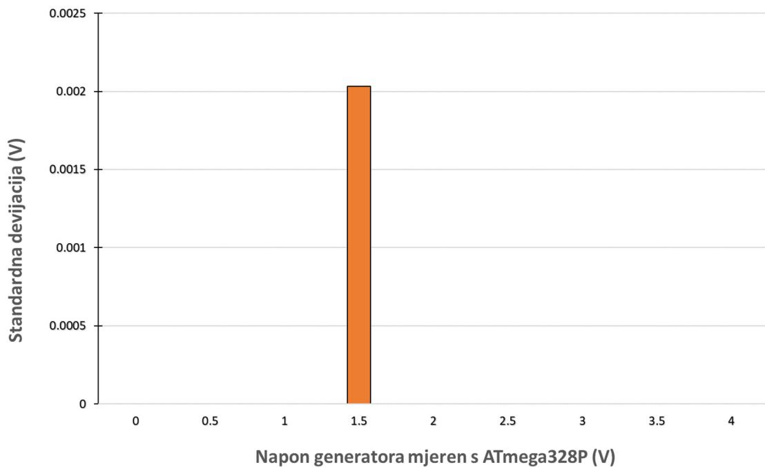
**Slika 5-4** Rasipanje mjerena Arduinom (ATmega328P) za napajanje baterijom
