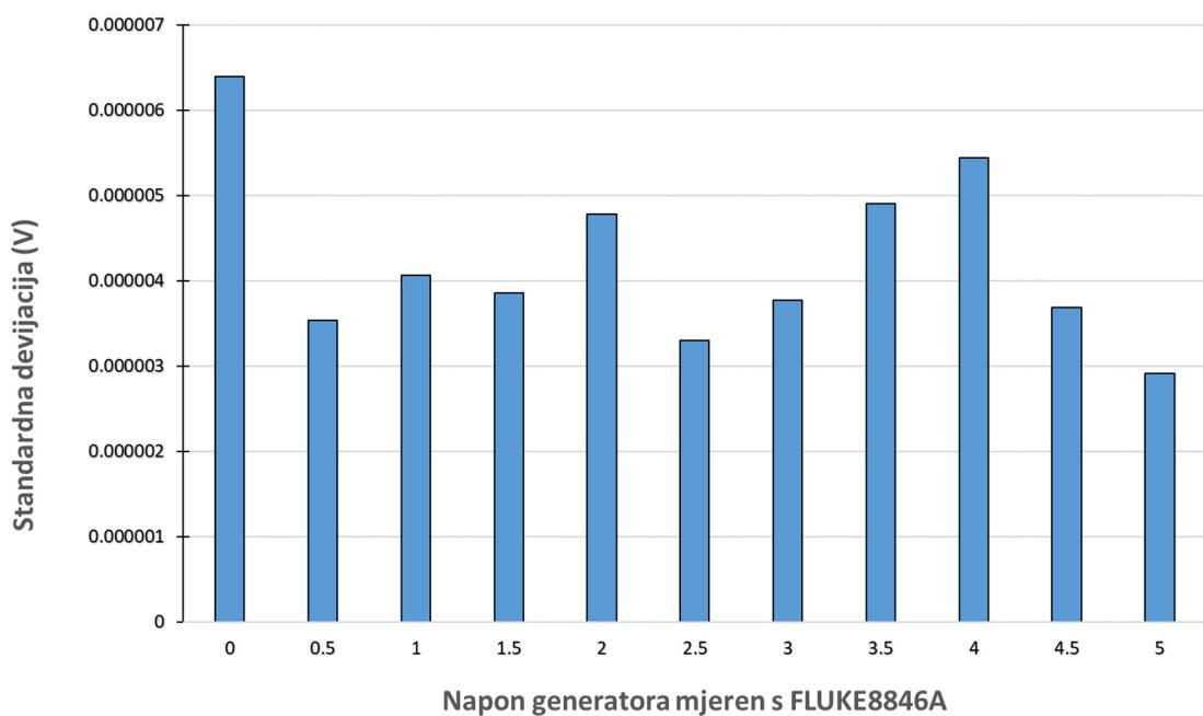
**Slika 5-2** Rasipanje mjerenja voltmetrom FLUKE za napajanje USB-priklučkom
