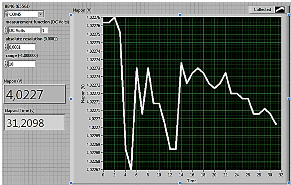
Slika 4-18 Mjerenje napona baterije u strujnom krugu za vrijeme mjerena Arduina
