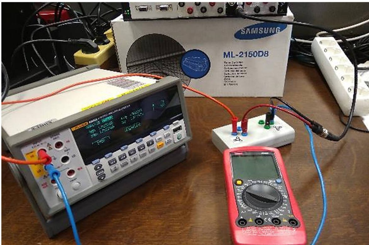
Slika 4-14 Mjerenje analognog napona mjerne kartice preko bloka SC-2345
