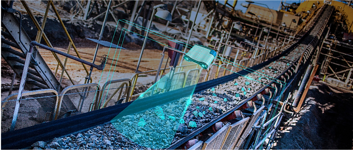
Slika 3-9 Autonomni sustav za određivanje fragmentacije odminiranog materijala nad transportnom trakom ( Mining.com , 2019b)
