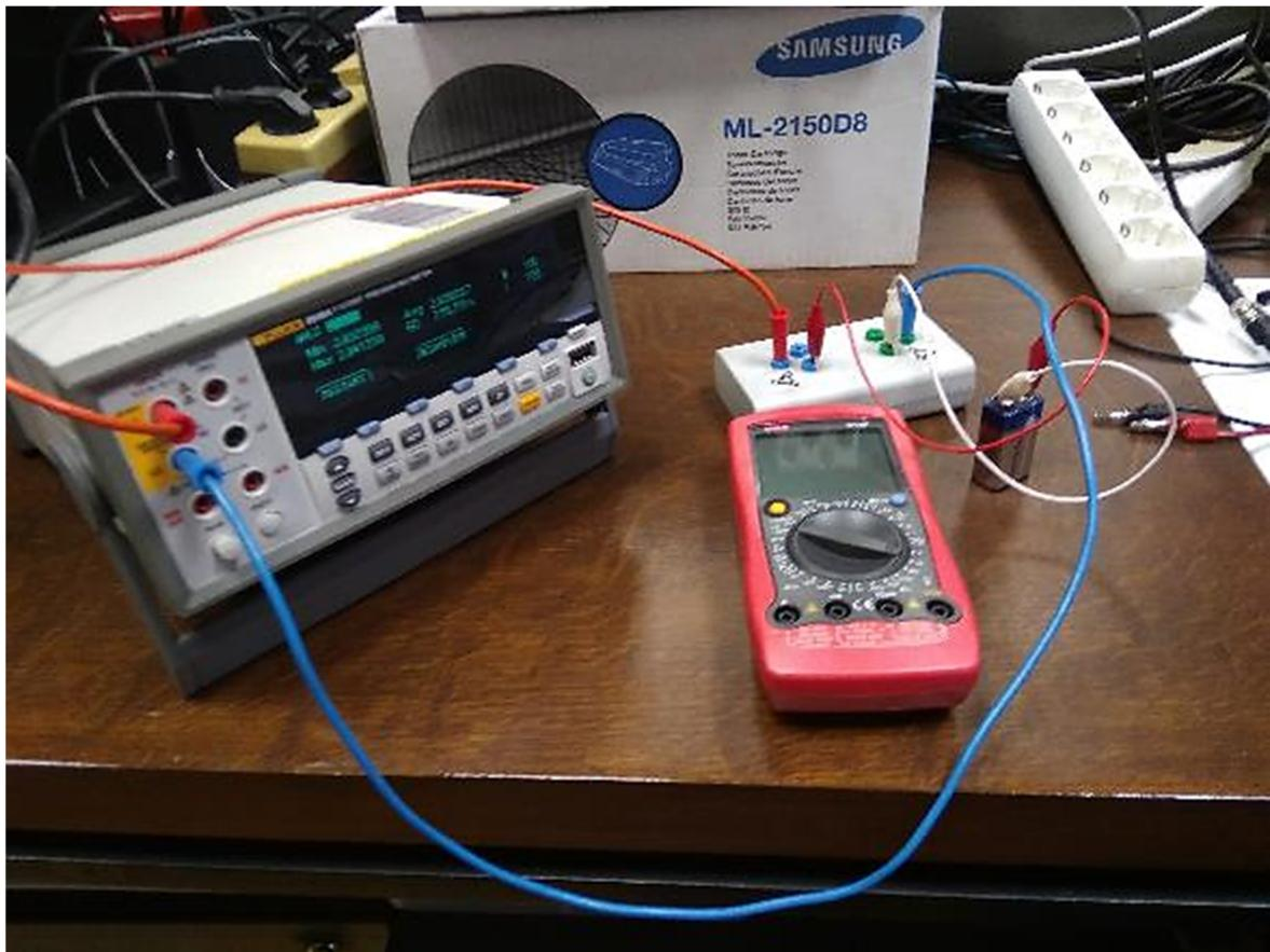
Slika 4-12 Mjerjenje istosmjernog napona baterije preciznim voltmetrom FLUKE 8846A
