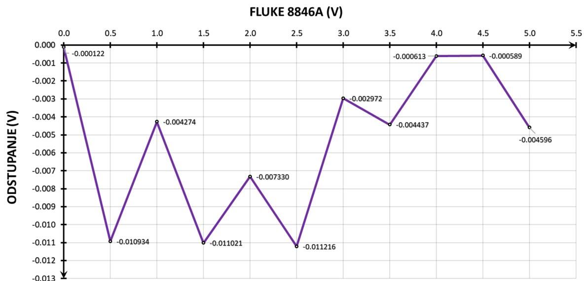
Slika 5-3 Odstupanje mjerena Arduinom u odnosu na FLUKE za napajanje USB-portom
