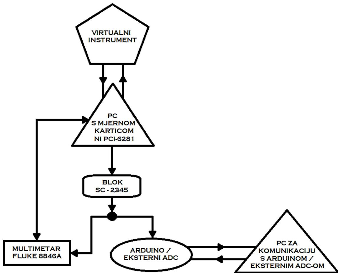
**Slika 4-3** Blok dijagram spajanja uređaja za određivanje **točnosti i stabilnosti mjerjenja**
