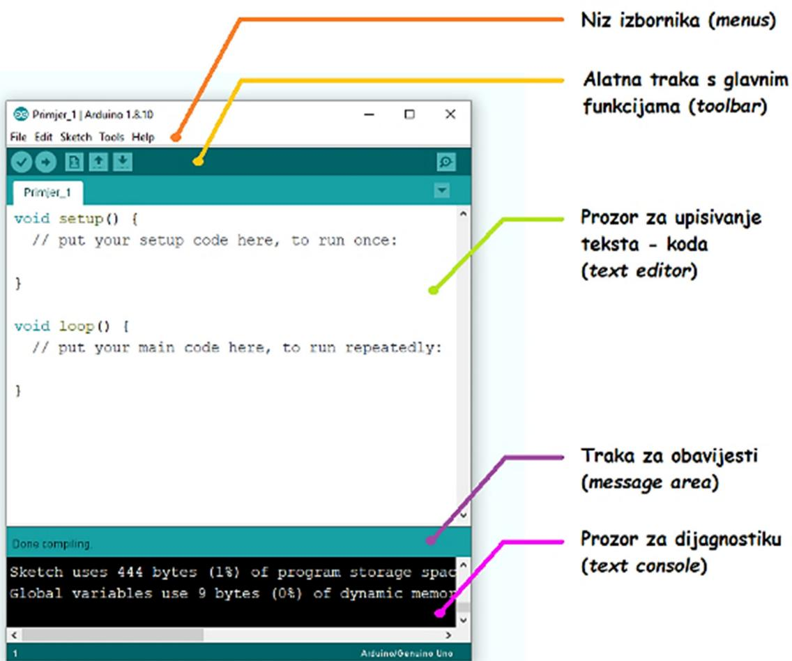
Slika 2-4 Prozor Arduino *Software*-a s opisom glavnih elemenata
