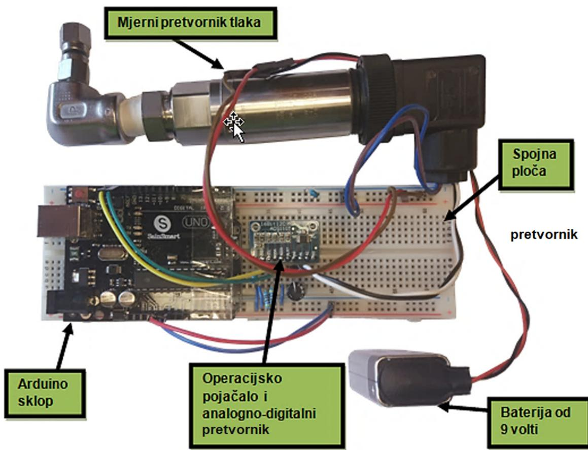
Slika 3-10 Uređaj za mjerjenje tlaka (Juranko, 2018)
