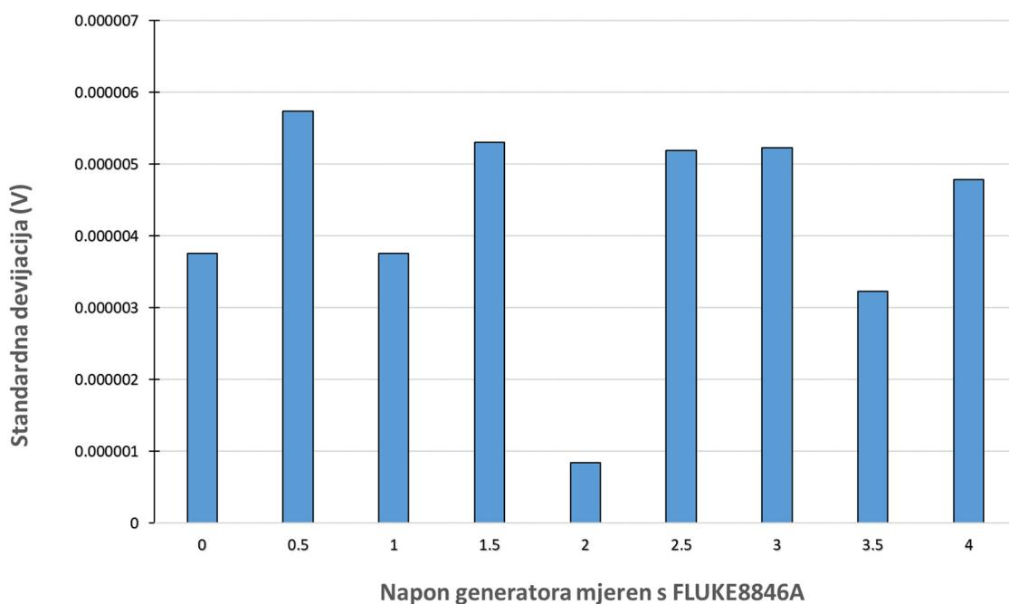
**Slika 5-5** Rasipanje mjerena voltmetrom FLUKE za napajanje baterijom
