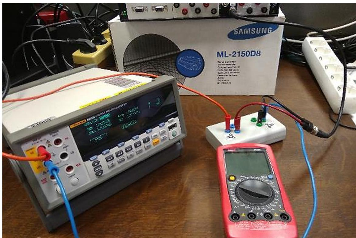
Slika 4-14 Mjerjenje analognog napona mjerne kartice preko bloka SC-2345
