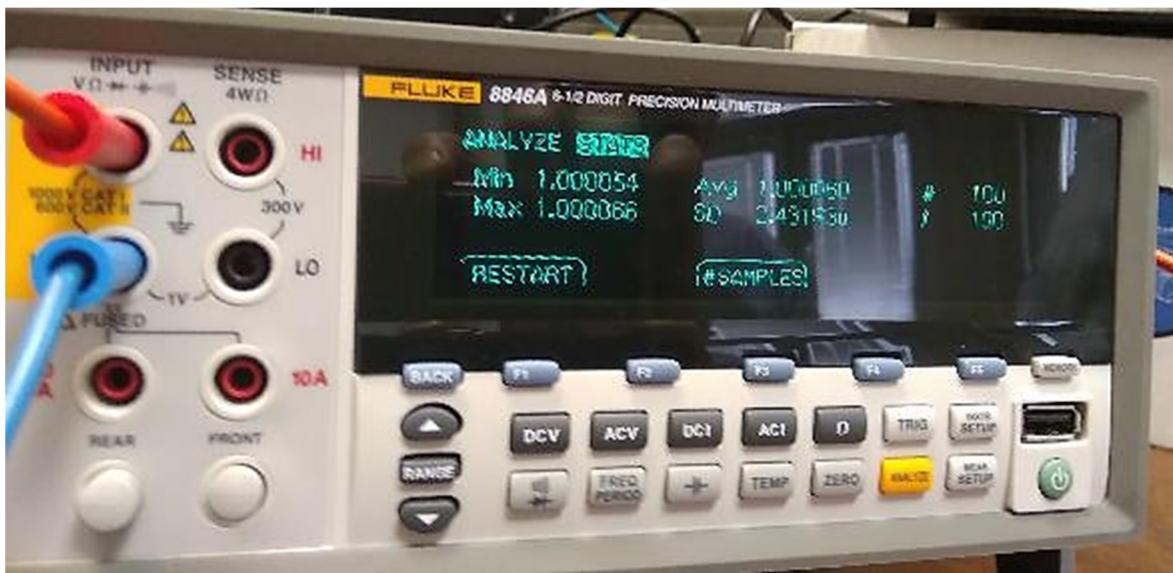
Slika 4-15 Određivanje šuma referentnog voltmetra FLUKE 8846A
