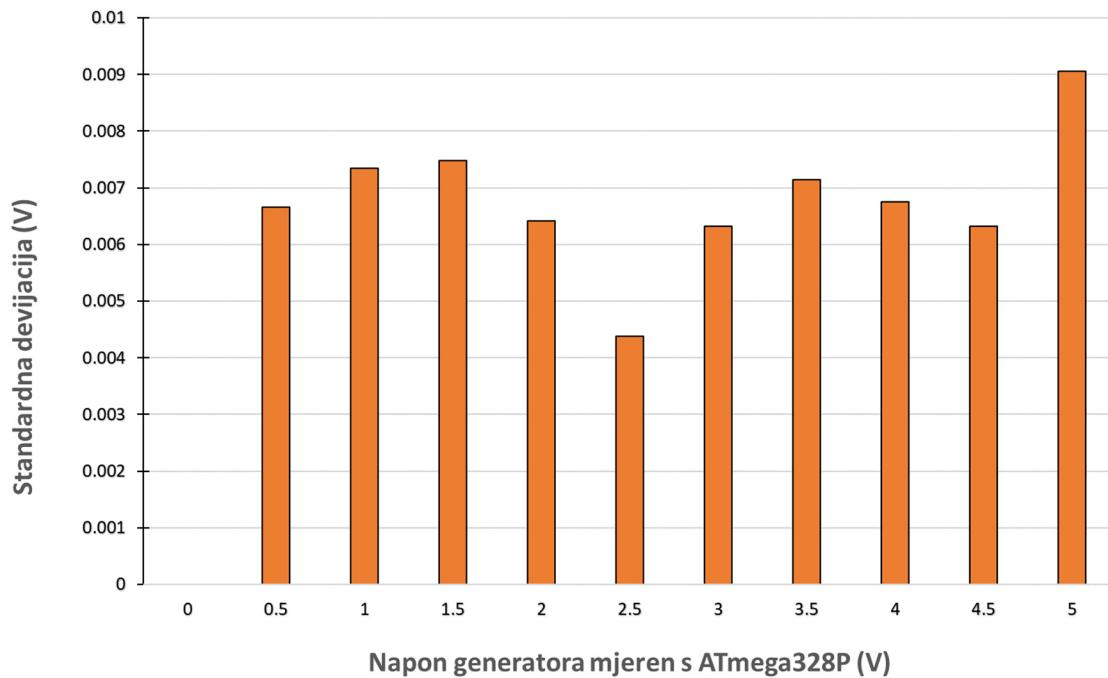
**Slika 5-1** Rasipanje mjerenja Arduinom (ATmega328P) za napajanje USB-priklučkom
