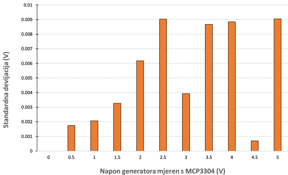
Slika 5-7 Rasipanje mjerena Arduinom (MCP3304) za napajanje USB-priklučkom
