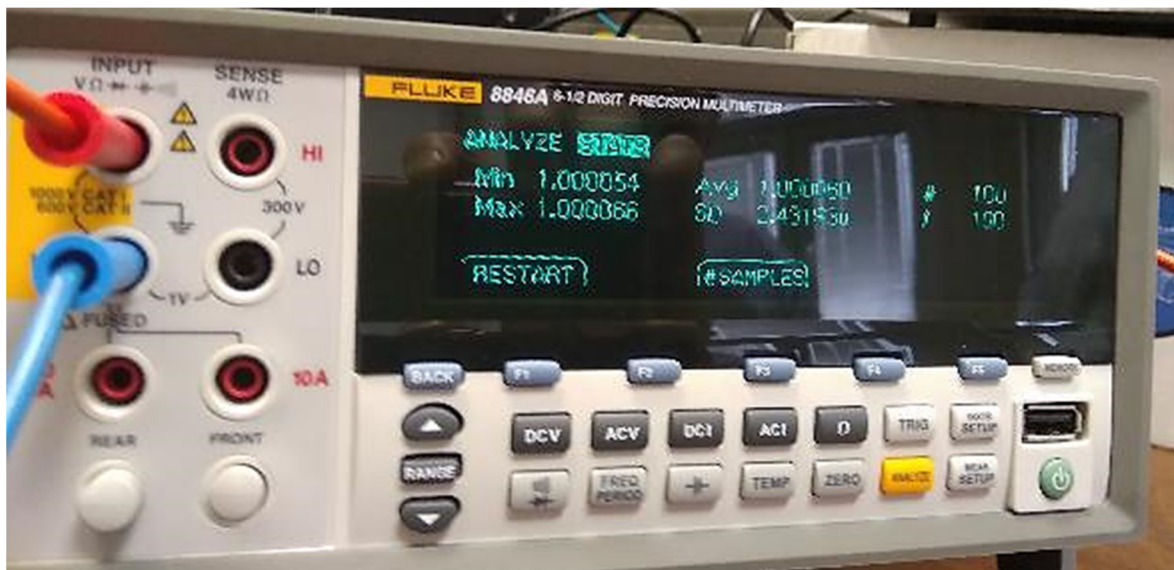
Slika 4-15 Određivanje šuma referentnog voltmetra FLUKE 8846A
