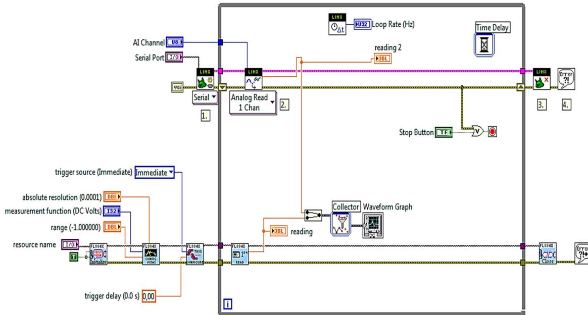
Slika 4-22 Blok dijagram virtualnog instrumenta za direktnu usporedbu mjerena
